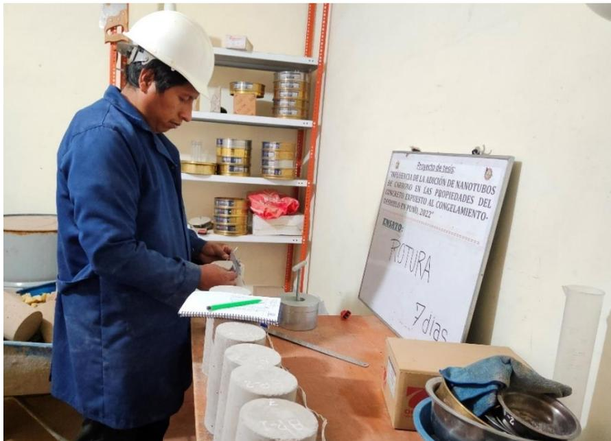
**Figura 12** “Medición de los diámetros de los especímenes de concreto”
