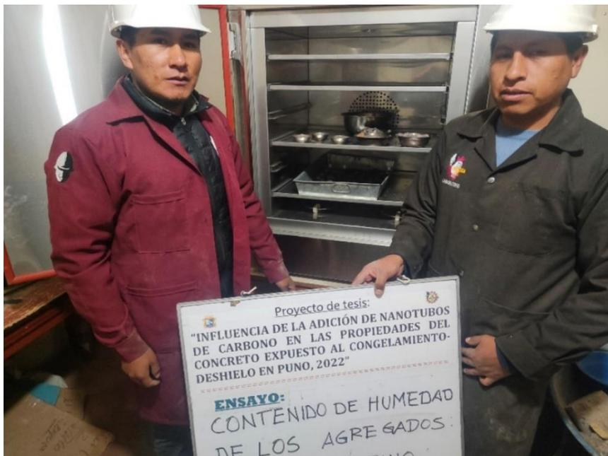
*Fotografía 2. “Muestras de agregado en el horno de  $110^{\circ}\text{C} \pm 5^{\circ}\text{C}$ , para contenido de humedad”*
