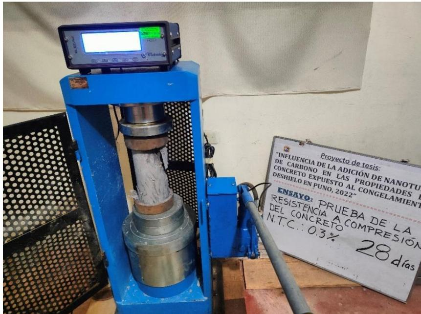
*Figura 13 "Ensayo de resistencia a la compresión"*
