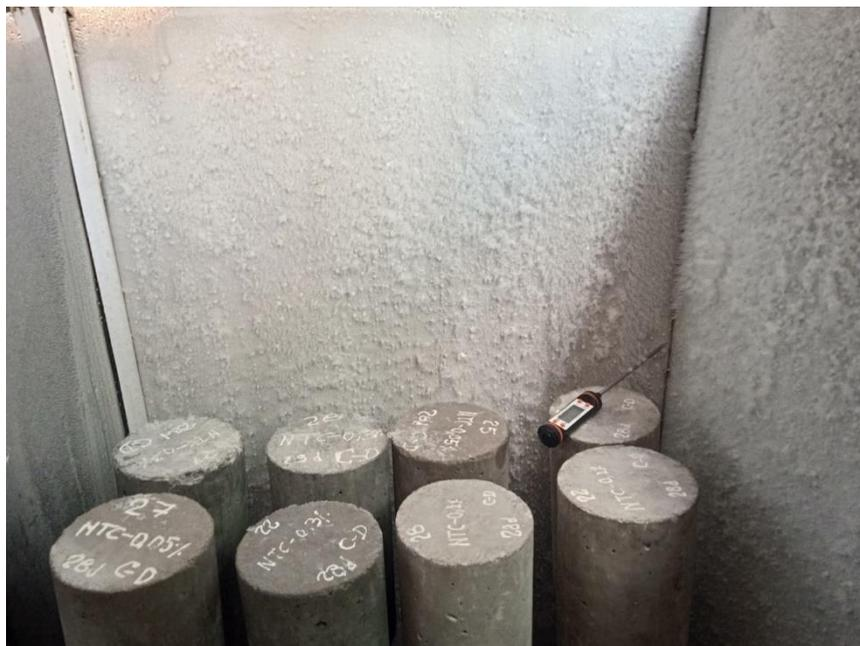
*Figura 10 “Especímenes cilíndricas expuestas al congelamiento”*
