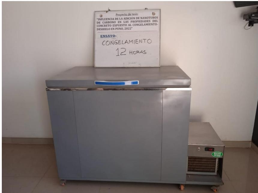
*Figura 9 “Equipo calibrado que simula el congelamiento”*
