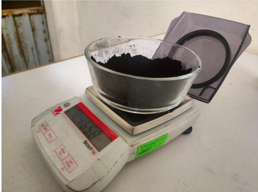
*Figura 5 “Peso de los nanotubos de carbono”*
