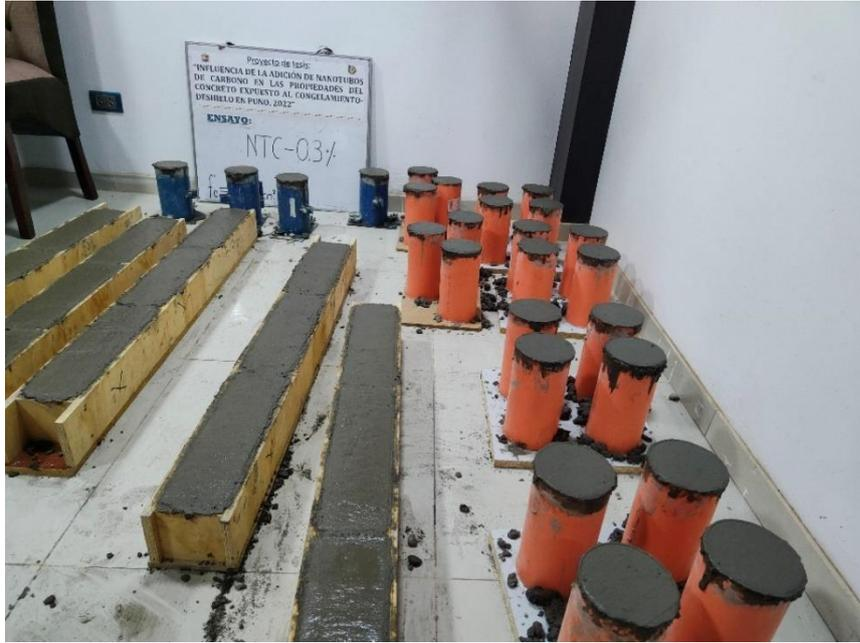
**Figura 7 “Elaboración de los especímenes de concreto”**
