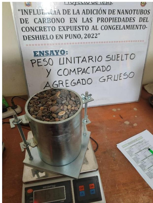
*Figura 4. “Ensayo de peso unitario suelto y compactado del agregado grueso”*
