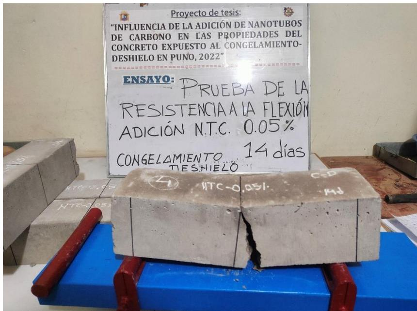
*Figura 16 “Falla en el punto central, ensayo de la resistencia a flexión”*
