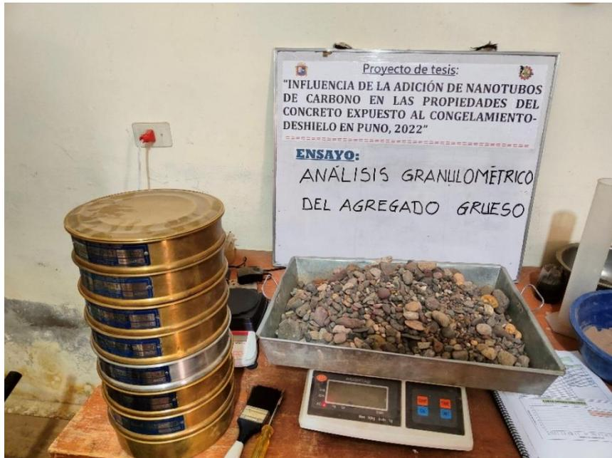
*Figura 3 “Peso del agregado grueso para el análisis granulométrico”*
