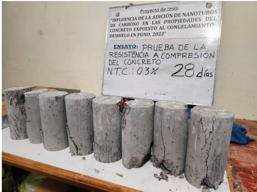
*Figura 15 “Fallas, ensayo de la resistencia a compresión”*
