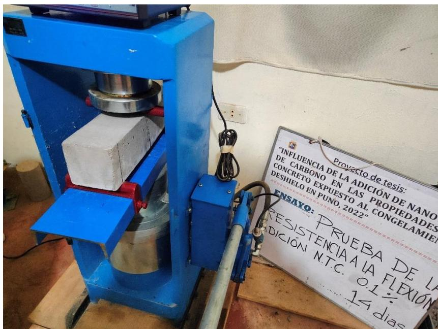
*Figura 14 "Ensayo de resistencia a la flexión"*
