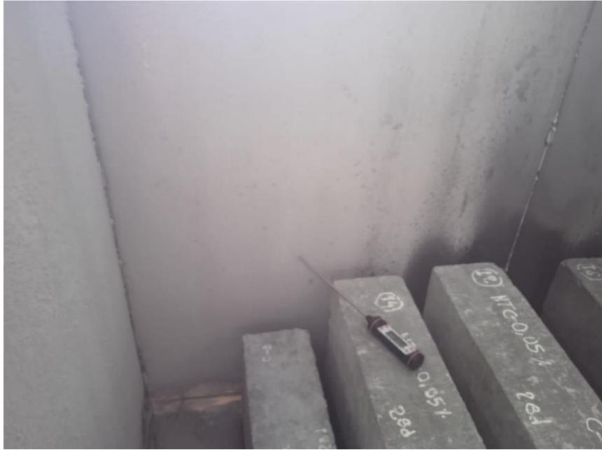
**Figura 11** “Especímenes prismáticos expuestos al congelamiento”
