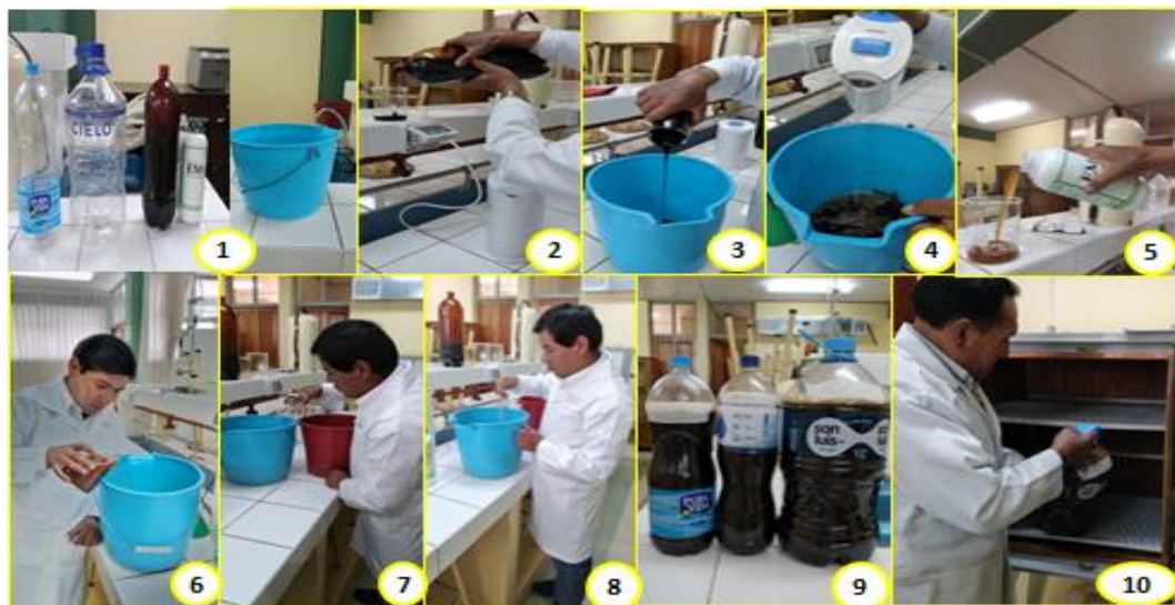
Figura 21. Proceso de activación del EM: (1) Insumos, (2) y (3) Vertido de melaza por dosis y vertido al balde, (4) Vertido de agua caliente para homogenizar la melaza, (5) Vertido del EM en probeta de 1 lt, (6) vertido de la dosis de EM en balde, (7) Aumento de agua hasta completar, (8) Homogenizado de la mezcla, (9) Solución preparada que será el EMA activado, (10) puesta en equipo para su fermentación respectiva.
