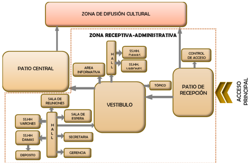
Figura 96: Organigrama de Distribución - Zona Administrativa Fuente: Elaborado por el equipo de trabajo
