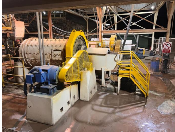
Figura 25. Molinos de bolas 5x10 ft – 5x8 ft de la planta flotación
