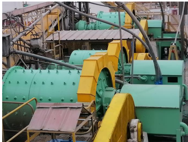
Figura 27. Molinos de Bolas 6x6 ft – 5x6 ft – 5x8 ft del circuito de cianuración
