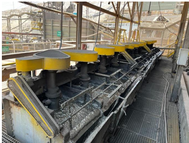
Figura 26. Circuito de flotación Celdas Sub-A 24x24.
