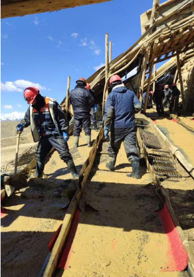
Foto 03 - Frente Cominra, personal en la canaleta preparado para realizar el lavado de alfombras y posterior recojo de concentrado.
