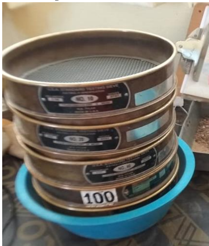
Fotografía 6 Ensayo de granulometría tamizado de materiales finos
