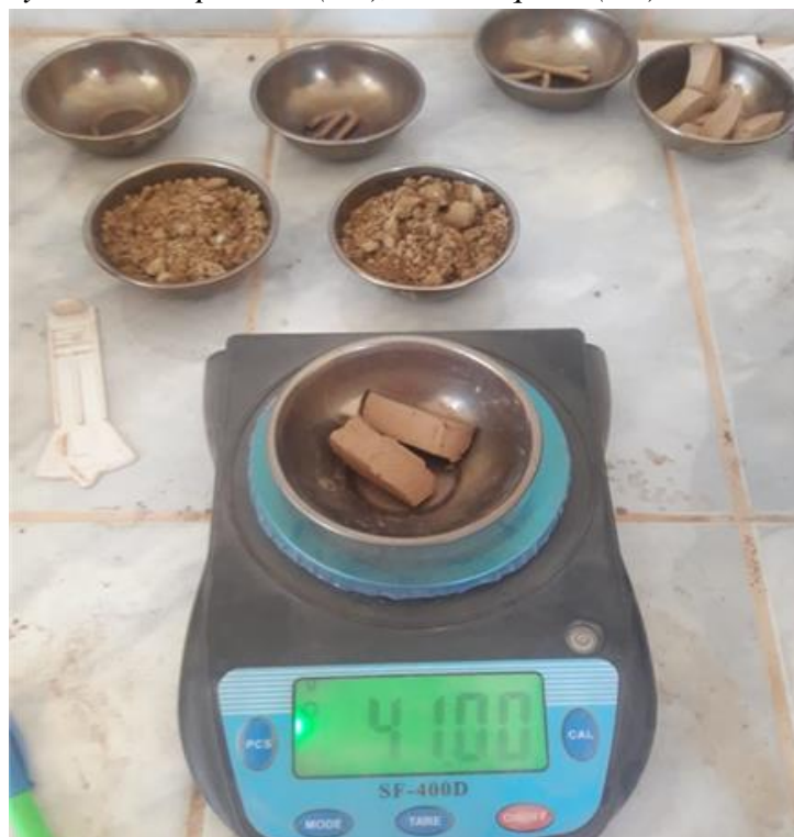
Fotografía 10 Toma del peso del ensayo de límites de consistencia
