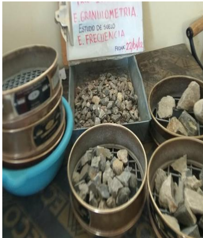
Fotografía 7 Ensayo de granulometría tamizado de materiales gruesos
