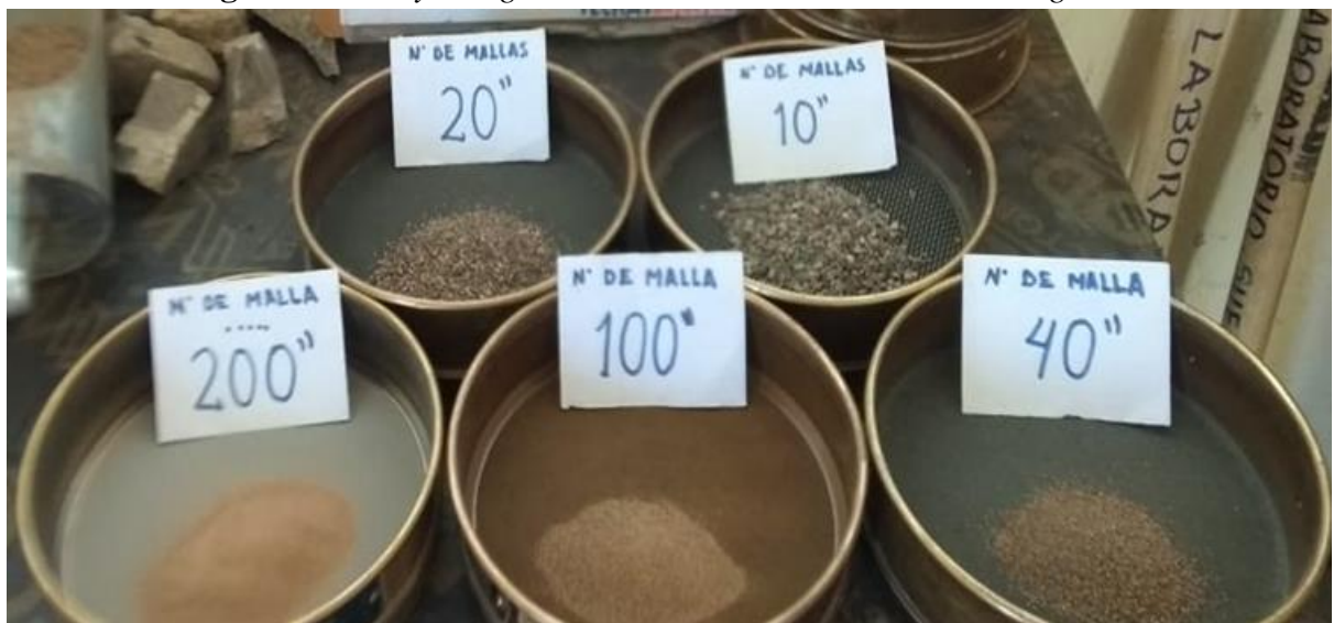
Fotografía 8 Ensayo de granulometría material retenido en las mallas
