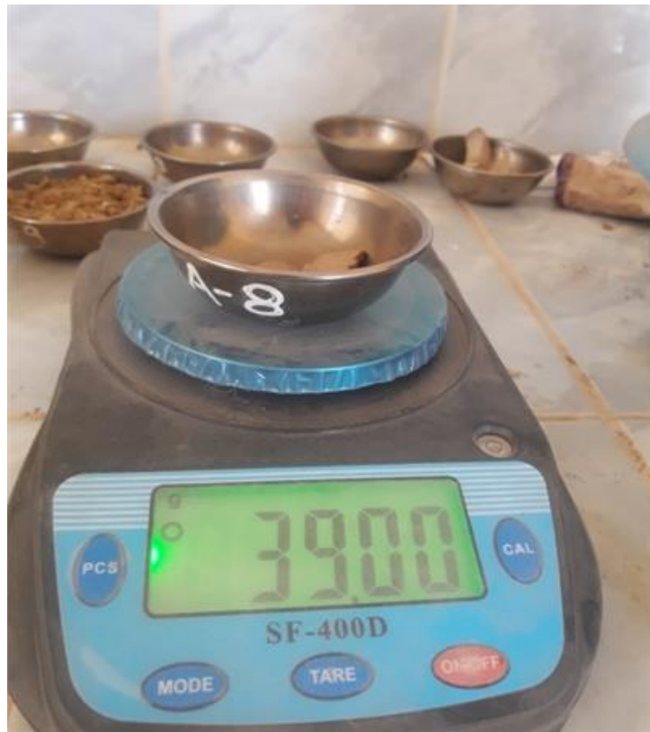
Fotografía 9 Ensayo de limite plástico (LP), limite líquido (LL) e índice de plasticidad (IP)
