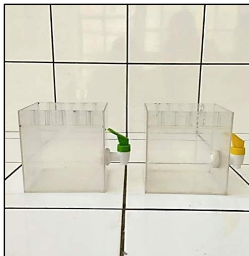
Figura 6. Celdas con válvula de descarga
