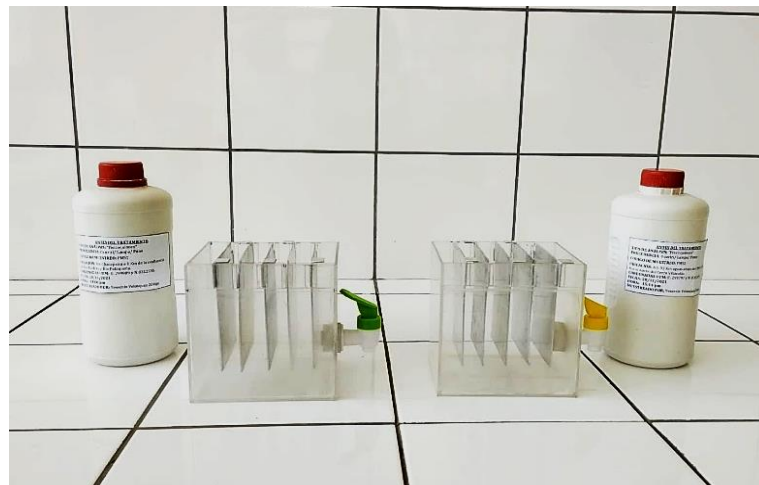
Figura 43. Electrodo de aluminio distribuidos en paralelo
