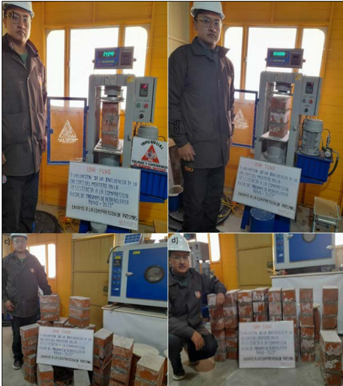
Nota. a) Ensayo a la compresión de prismas de albañilería - Viluyo. b) Ensayo a la compresión de prismas de albañilería - Cutimbo. c) Prismas de albañilería ensayados – Viluyo. d) Prismas de albañilería ensayados – Cutimbo.
