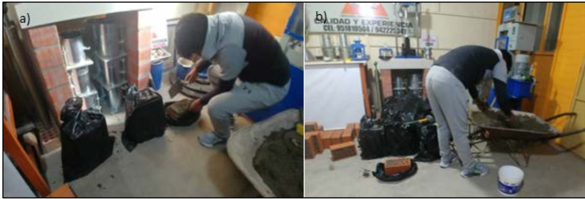
Nota. a) Construcción de prismas de albañilería. b) Sellado de prismas en bolsas de plástico.
