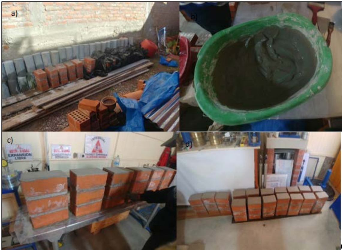
Nota. a) Desembolsado de prismas de albañilería. b) Preparación de mezcla de yeso y cemento para el refrentado de prismas. c) Refrentado de prismas de albañilería d) Prismas de albañilería listos para ser ensayados.
