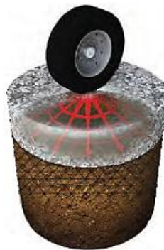
FIGURA III.44: Mecanismo de mejoramiento de capacidad de soporte.
