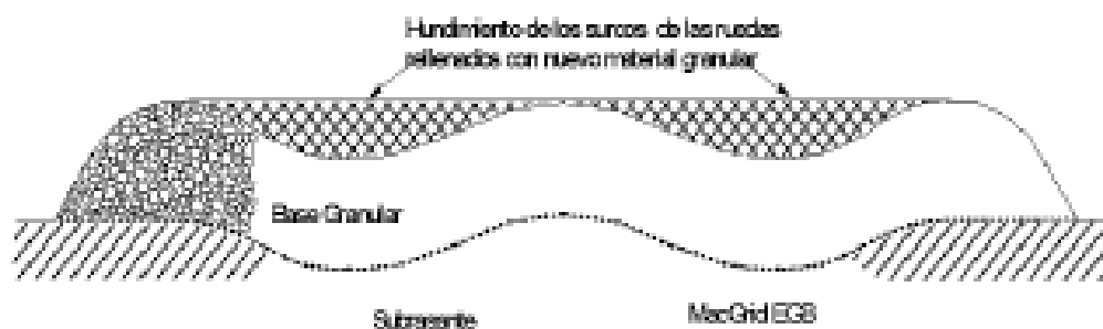
Figura 02: Hundimiento de los surcos de las ruedas.
