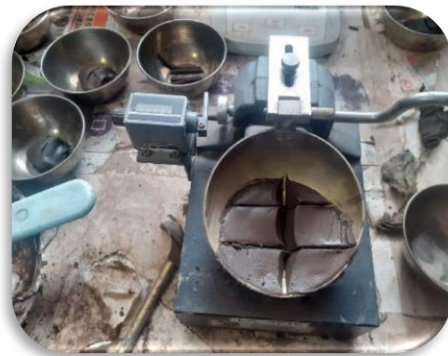
FIGURA 19: Ensayo de límites de consistencia. Fuente: Elaboración propia.
