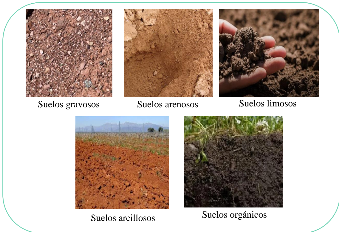
FIGURA 6: Tipos de suelos según a sus características físicas, químicas y mecánicas. Fuente: Rosas, 2012.
