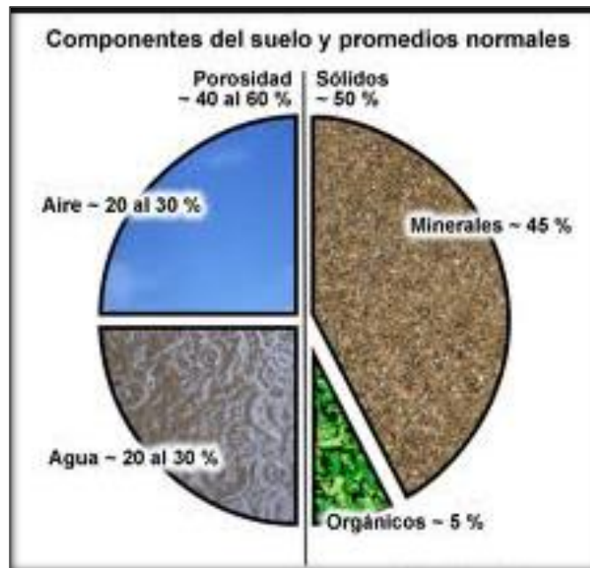
FIGURA 5: Componentes y partes de un suelo. Fuente: Rosas, 2012.
