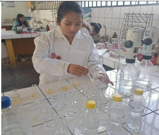
Colocando gotas de indicador a la muestra
