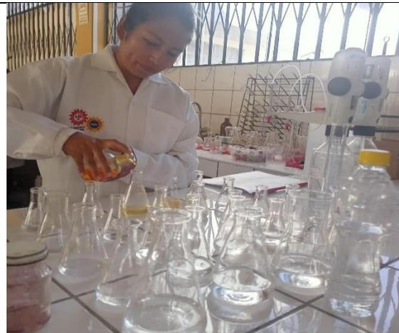
Colocando gotas de indicador a la muestra
