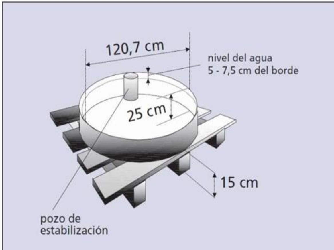
Figura 13. Características del tanque clase A
