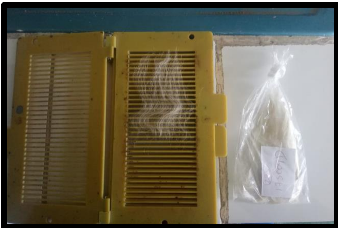
Figura 7. Colocación de las muestras de fibra sobre el slide
