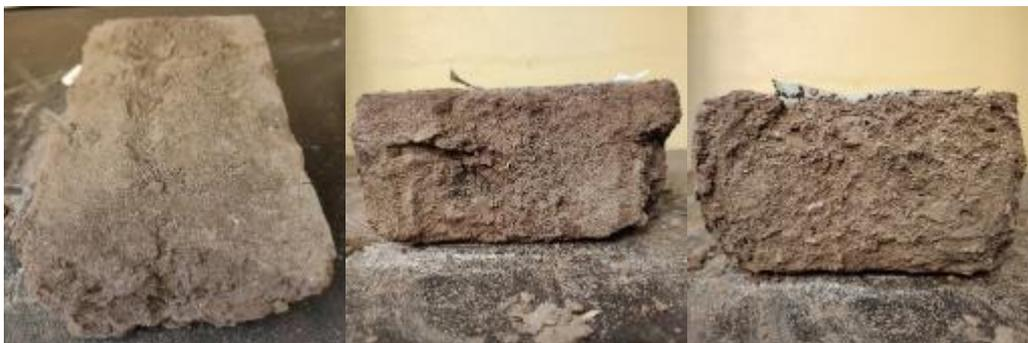
En la *Figura 57* se ve la erosión sufrida por los bloques a causa de la saturación, al tacto los bloques se sienten “gelatinosos”.
