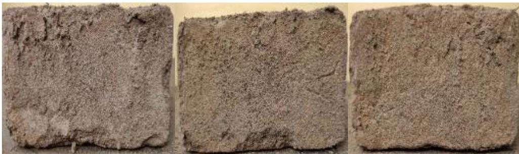
Los bloques sufrieron erosión moderada en la testa inferior (*Figura 67*), a causa del agua escurrida, es decir que la mayoría de parte erosionada no se causó por el impacto de la caída de agua, sino más bien por la escorrentía causada por esta.
