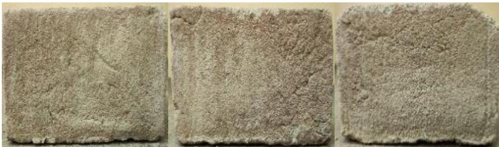
Los bloques sufrieron erosión leve en la testa inferior (*Figura 73*), a causa del agua escurrida, es decir que la mayoría de parte erosionada no se causó por el impacto de la caída de agua, sino más bien por la escorrentía causada por esta.
