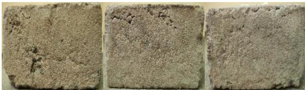
Los bloques sufrieron erosión moderada a leve en la testa inferior (*Figura 71*), a causa del agua escurrida, es decir que la mayoría de parte erosionada no se causó por el impacto de la caída de agua, sino más bien por la esorrentía causada por esta.
