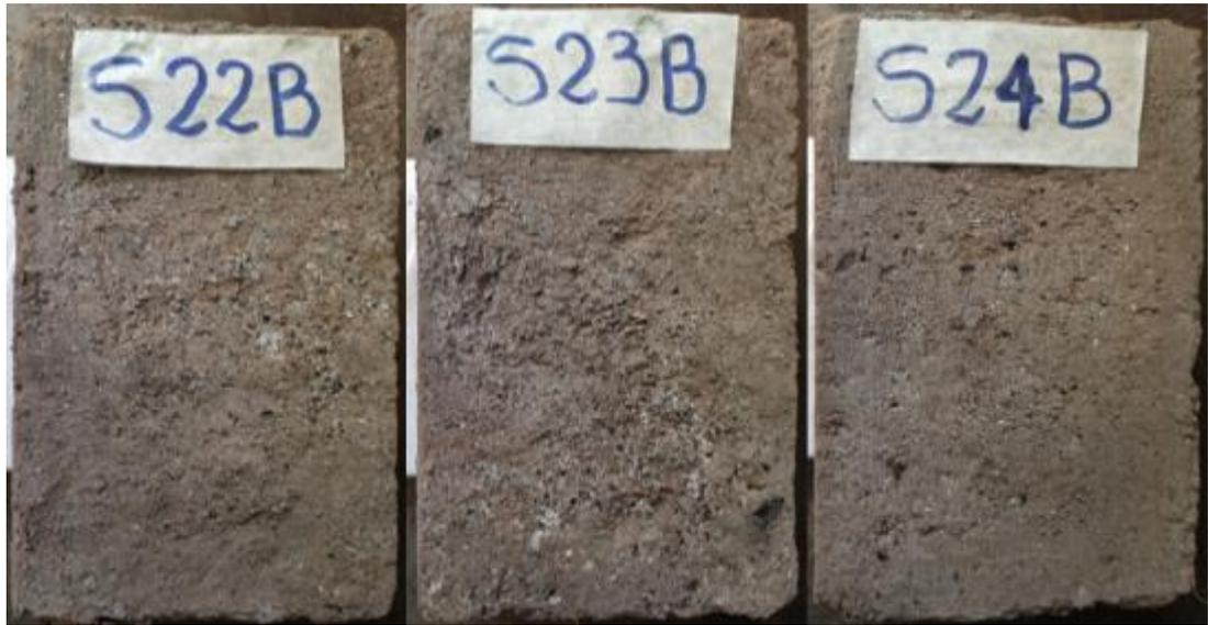
Los bloques S22, S23, S24 se evaluaron por la cara B. Después de los 20 minutos del ensayo en los bloques no se aprecia oquedades, pero si arrastre de material, como puede observarse en la *Figura 66*. El bloque S22B presento una penetración de 2.9 mm; el bloque S23B una penetración de 3.6 mm; y el bloque S24B una penetración de 3 mm, sin superar los tres bloques el límite permitido para ser considerados aptos.
