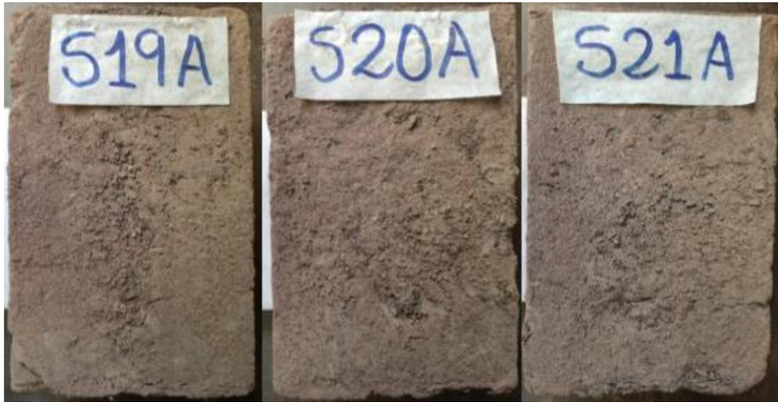
Los bloques S19, S20, S21 se evaluaron por la cara A. Después de los 20 minutos del ensayo en los bloques no se aprecia oquedades pero si arrastre de material, como puede observarse en la *Figura 64*. El bloque S19A presento una penetración de 4.5 mm; el bloque S20A una penetración de 4.8 mm; y el bloque S21A una penetración de 5 mm, sin superar los tres bloques el límite permitido para ser considerados aptos.
