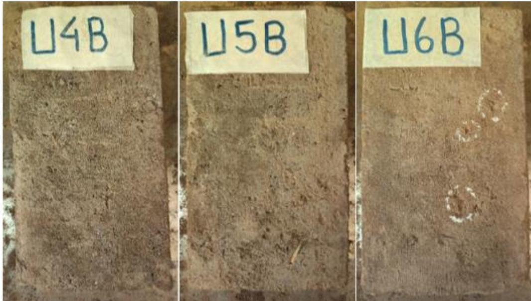
Los bloques U4, U5, U6 se evaluaron por la cara B. Después del ensayo los bloques no sufrieron erosión significativa, considerándose intactos como se puede observar en la *Figura 54*. El bloque U4B después de los primeros 15 minutos de ensayo no presento una penetración, a los 30 minutos presento una penetración de 0.5 mm, a los 45 minutos una penetración de 0.8 mm; y a los 60 minutos una penetración de 1 mm.
