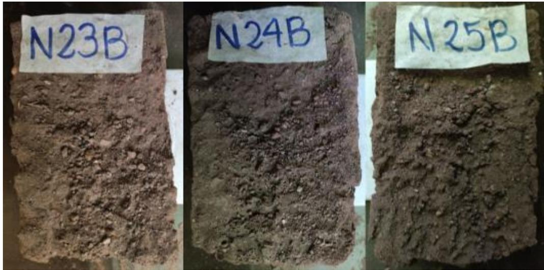
Los bloques N23, N24, N25 se evaluaron por la cara B. Después de los 20 minutos del ensayo en los bloques no se aprecia oquedades pero si arrastre de material, como puede observarse en la *Figura 58*. El bloque N23B presento una erosión de 10 mm; el bloque N24B una penetración de 9 mm; y el bloque N25B una penetración de 9 mm, sin superar los tres bloques el límite permitido para ser considerados aptos.
