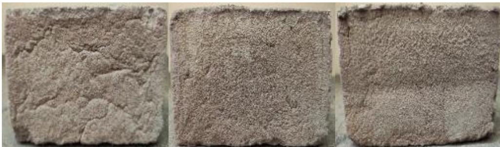
Los bloques sufrieron erosión leve en la testa inferior (*Figura 75*), a causa del agua escurrida, es decir que la mayoría de parte erosionada no se causó por el impacto de la caída de agua, sino más bien por la escorrentía causada por esta.
