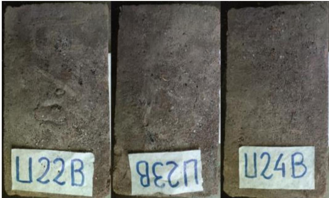
Los bloques U22, U23, U24 se evaluaron por la cara B. Después de los 20 minutos del ensayo en los bloques no se aprecia oquedades, pero si arrastre de material, como puede observarse en la *Figura 74*. El bloque U22B presento una penetración de 1.2 mm; el bloque U23B una penetración de 1.1 mm; y el bloque U24B una penetración de 0.7 mm, sin superar los tres bloques el límite permitido para ser considerados aptos.
