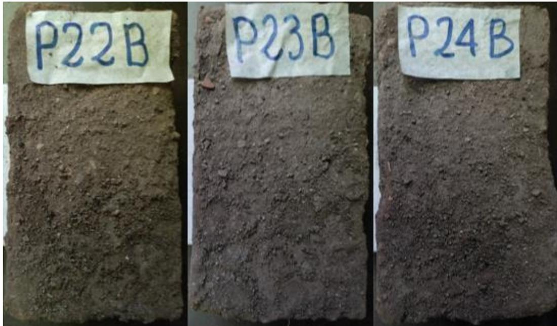
Los bloques P22, P23, P24 se evaluaron por la cara B. Después de los 20 minutos del ensayo en los bloques no se aprecia oquedades pero si arrastre de material, como puede observarse en la *Figura 62*. El bloque P22B presento una erosión de 5 mm; el bloque P23B una penetración de 5 mm; y el bloque P24B una penetración de 5 mm, sin superar los tres bloques el límite permitido para ser considerados aptos.
