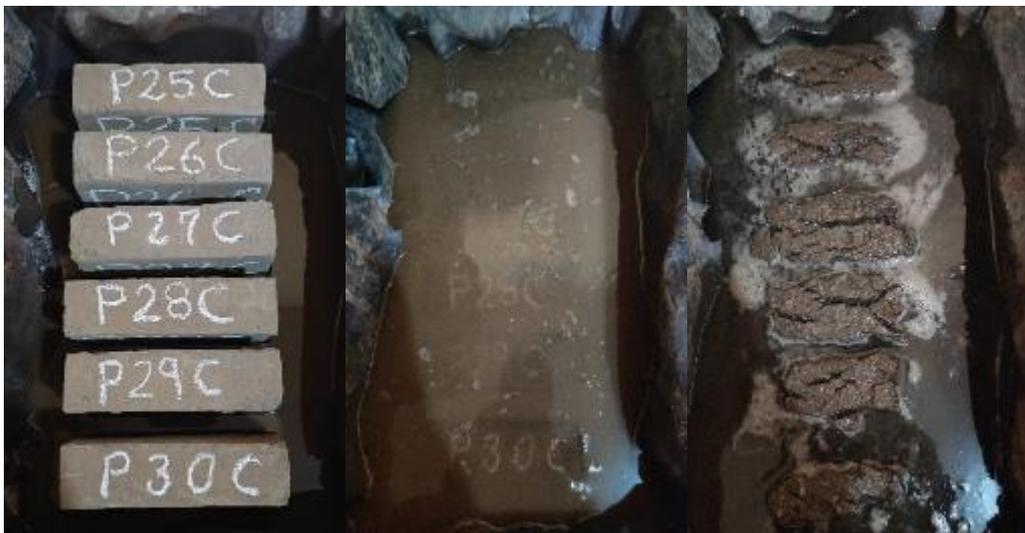
Los bloques P, se hincharon y se fraccionaron como muestra la *Figura 88*, en un lapso aproximado de 3 horas. Al tacto los bloques eran susceptibles de desintegración, por lo que fue imposible su pesaje.
