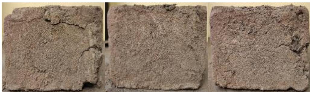
Los bloques sufrieron erosión moderada en la testa inferior (*Figura 65*), a causa del agua escurrida, es decir que la mayoría de parte erosionada no se causó por el impacto de la caída de agua, sino más bien por la escorrentía causada por esta.
