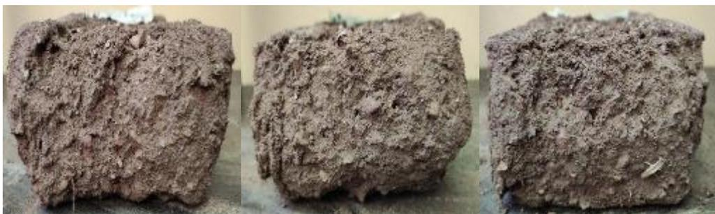
Los bloques sufrieron erosión severa en la testa inferior (*Figura 59*), a causa del agua escurrida, es decir, que la mayoría de parte erosionada no se causó por el impacto de la caída de agua, sino más bien por la escorrentía causada por esta.
