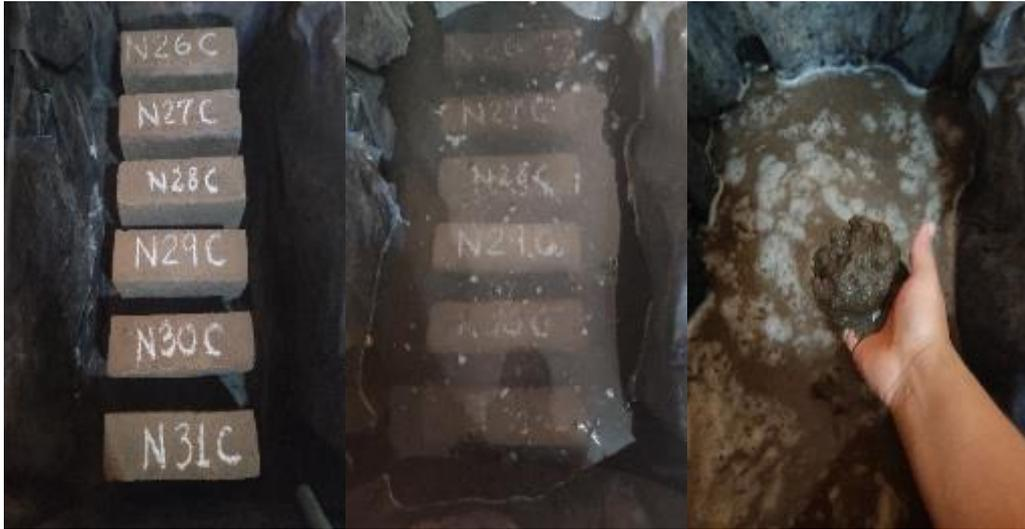
Como se observa en la *Figura 87*, los bloques N quedaron desintegrados en su totalidad, dicha desintegración sucedió en un lapso de 60 minutos. En esa condición no fue posible la toma de peso saturado.
