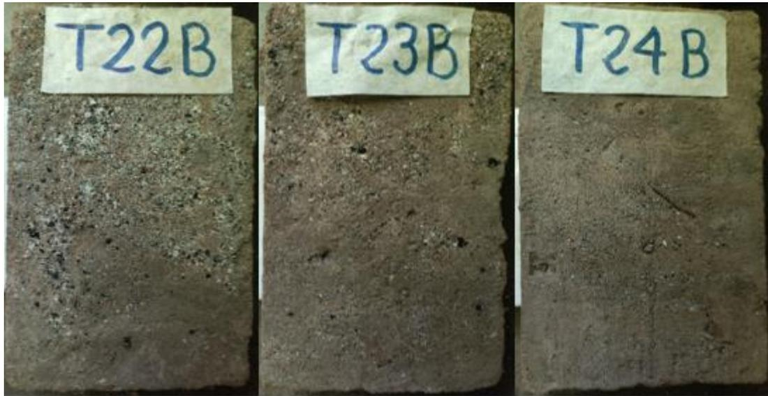
Los bloques T22, T23, T24 se evaluaron por la cara B. Después de los 20 minutos del ensayo en los bloques no se aprecia oquedades, pero si arrastre de material, como puede observarse en la *Figura 70*. El bloque T22B presento una penetración de 1.7 mm; el bloque T23B una penetración de 1.8 mm; y el bloque T24B una penetración de 2.1 mm, sin superar los tres bloques el límite permitido para ser considerados aptos.
