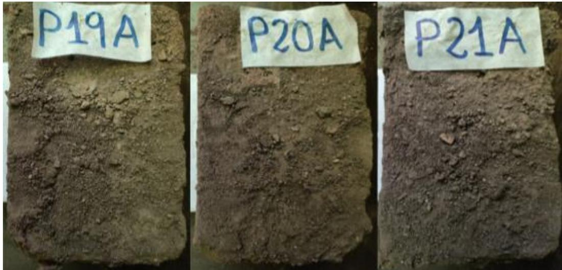
Los bloques P19, P20, P21 se evaluaron por la cara A. Después de los 20 minutos del ensayo en los bloques no se aprecia oquedades pero si arrastre de material, como puede observarse en la *Figura 60*. El bloque P19A presento una erosión de 7 mm; el bloque P20A una penetración de 7 mm; y el bloque P21A una penetración de 6 mm, sin superar los tres bloques el límite permitido para ser considerados aptos.
