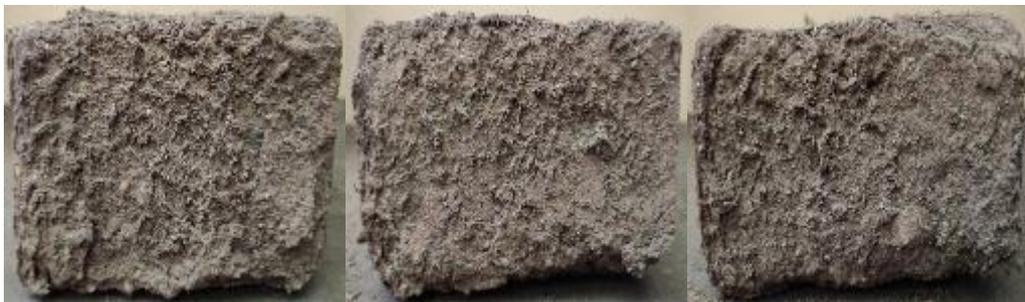
Los bloques sufrieron erosión alta en la testa inferior (*Figura 63*), a causa del agua escurrida, es decir que la mayoría de parte erosionada no se causó por el impacto de la caída de agua, sino más bien por la escorrentía causada por esta.
