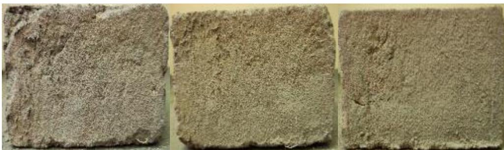
Los bloques sufrieron erosión moderada a leve en la testa inferior (*Figura 69*), a causa del agua escurrida, es decir que la mayoría de parte erosionada no se causó por el impacto de la caída de agua, sino más bien por la esorrentía causada por esta.
