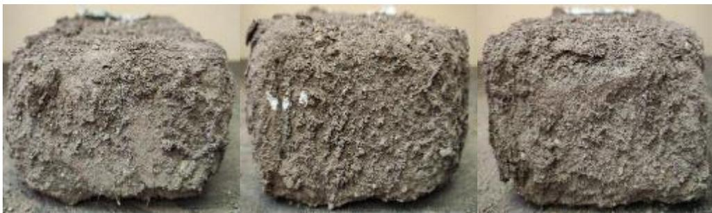
Los bloques sufrieron erosión alta en la testa inferior (*Figura 61*), a causa del agua escurrida, es decir que la mayoría de parte erosionada no se causó por el impacto de la caída de agua, sino más bien por la esorrentía causada por esta.
