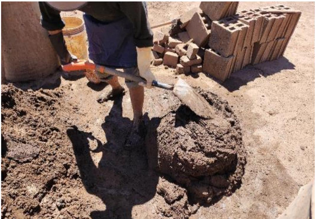
Nota: La masa para la fabricación de bloques, no se dejó reposar; pues el proceso de fraguado inicial por la presencia de cemento no lo permite.
