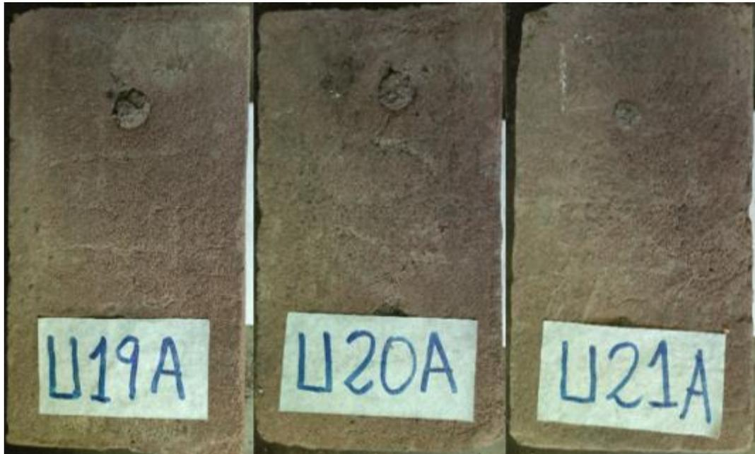
Los bloques U19, U20, U21 se evaluaron por la cara A. Después de los 20 minutos del ensayo en los bloques no se aprecia oquedades pero si arrastre de material, como puede observarse en la *Figura 72*. El bloque U19A presento una penetración de 1.7 mm; el bloque U20A una penetración de 1.6 mm; y el bloque U21A una penetración de 1.6 mm, sin superar los tres bloques el límite permitido para ser considerados aptos.
