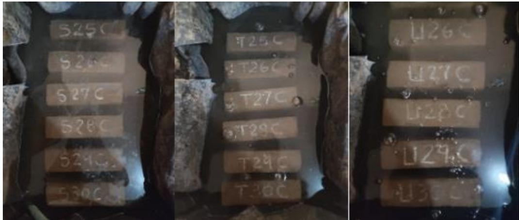
Los bloques S, T y U, completaron el ensayo sin sufrir agrietamientos, hinchamientos y/o desintegración, como se aprecia en la *Figura 89*.
