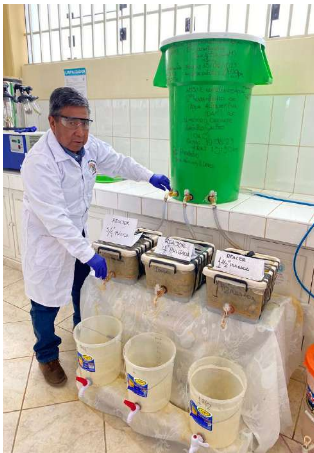
Figura 7. Reactor para drenaje anóxico calizo
