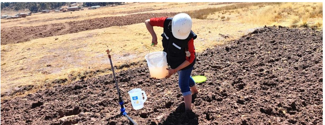
**Figura 28.** Vista de la medición del volumen de agua del aspersor
