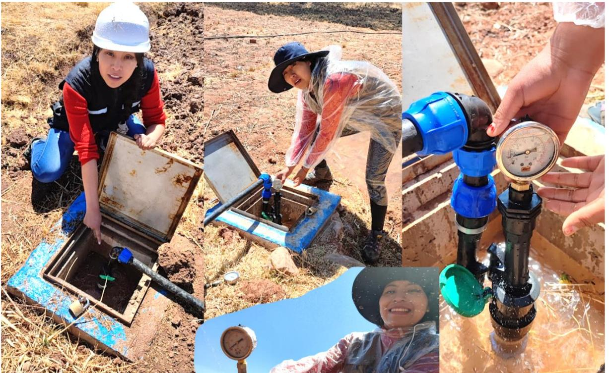
**Figura 27.** Vista de la medición de las presiones en los diferentes puntos
