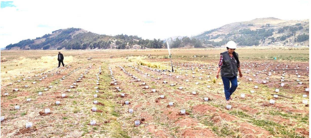
**Figura 33.** Vista de la prueba de aspersores y los colectores de pluviometría
