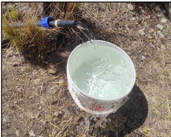
Medición de caudal de descarga
