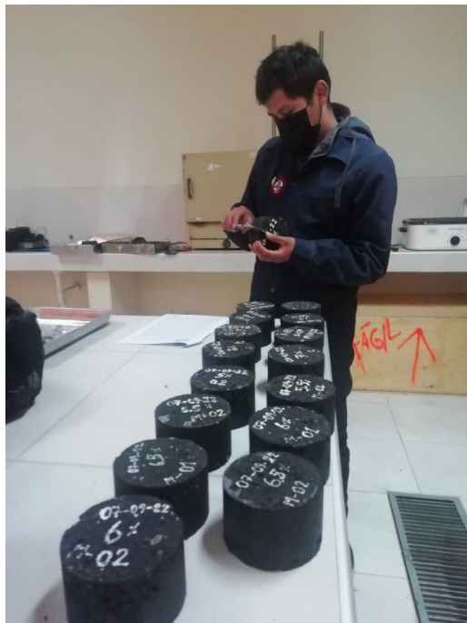
FOTO N° 25: Toma de datos de las medidas de los diámetros y alturas de especímenes.
