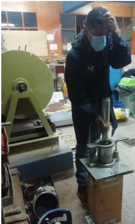
FOTO N° 23: compactación de la mezcla asfáltica en caliente.
