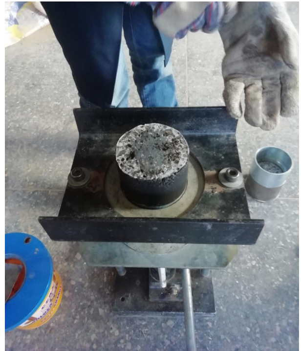
FOTO N° 24: desmolde del espécimen después de enfriado temperatura ambiente.
