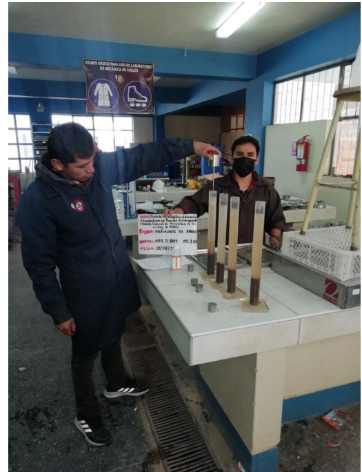
FOTO N° 18: En la imagen los tesistas aplicando el procedimiento del ensayo equivalente de arena.
