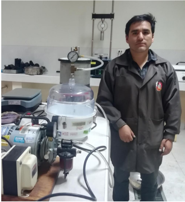
FOTO N° 29: Equipo de Bomba de vacios para su posterior aplicacion en el ensayo RICE
