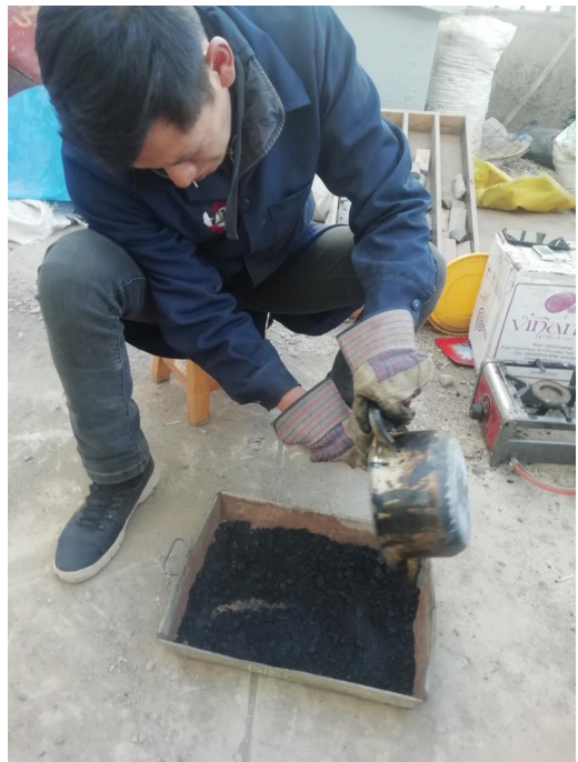
FOTO N° 30: Preparacion de la mezcla para el ensayo RICE
