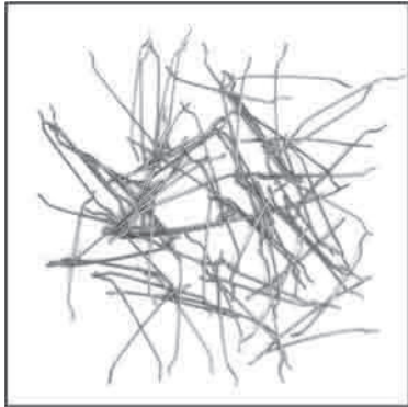
Macrofibras de acero anclada suelta.
