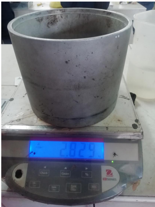
FOTO N° 31: Pesaje del recipiente parte del equipo para el ensayo RICE
