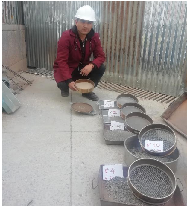
FOTO N° 01: Ensayo de granulometría de los agregados pétreos.
