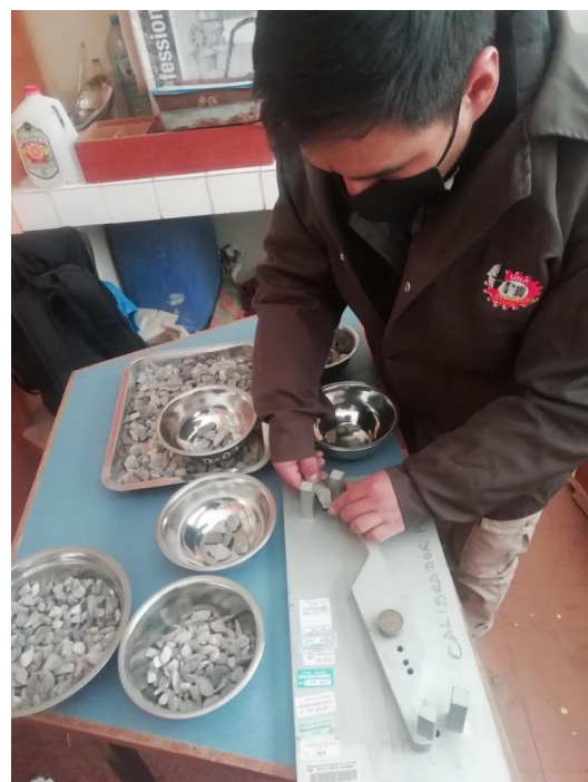
FOTO N° 12: Medición de las partículas chatas y alargadas.
