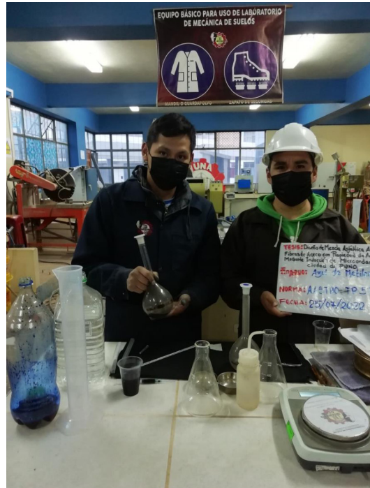
FOTO N° 14: En la imagen los tesis realizando el ensayo de azul metileno a los agregados finos .
