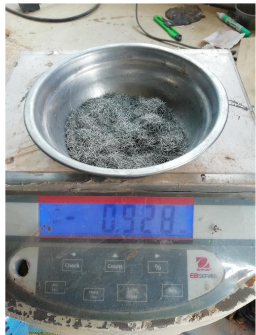
FOTO N° 28: Dosificación de las fibras de acero para su posterior mezclas con los agregados petreos .
