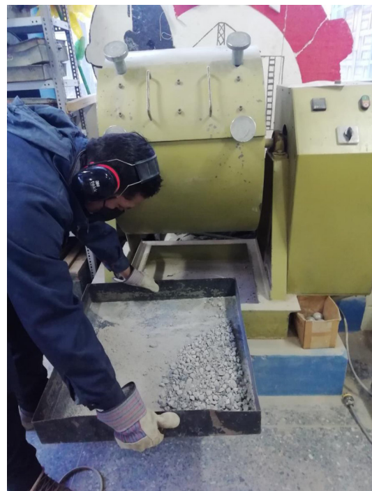
FOTO N° 16: Recoleccion de partículas después del ensayo de abrasion los ángeles.
