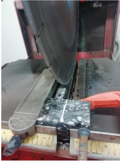
FOTO N° 37: Corte de ranura para la induccion de fisuras al aplicar cargas.
