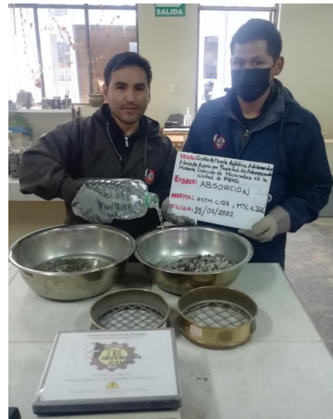
FOTO N° 10: Ensayo de absorción de agregado grueso. En la imagen el proceso de saturación del agregado.
