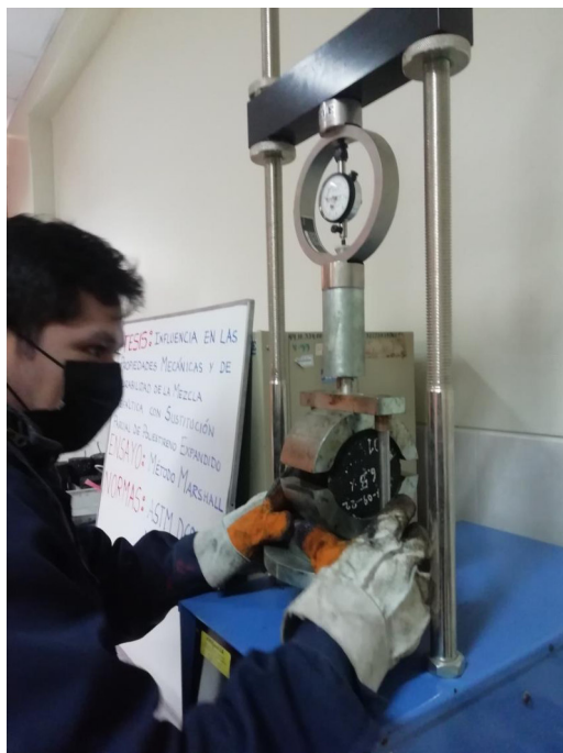
FOTO N° 27: Rotura de los especímenes en el equipo Marshall
