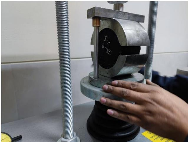
Nota: Realizando el ensayo Marshall
