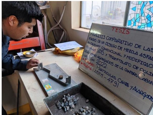
*Fotografía 5. Ensayo de partículas chatas y alargadas*
