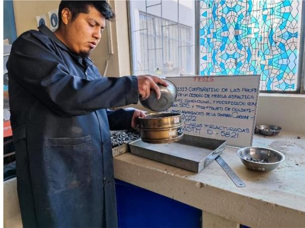
*Fotografía 4. Ensayo de caras fracturadas*
