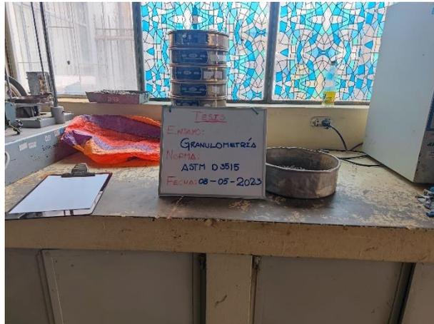
*Fotografía 2. Ensayo de granulometría*
