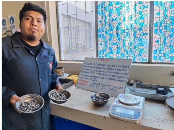
Nota: Realizando el ensayo de caras fracturadas
