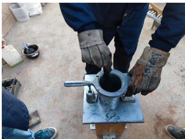
Nota: Elaborando testigos de ensayo Marshall
