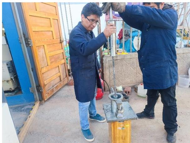
*Fotografía 6. elaboración de probetas de asfalto*
