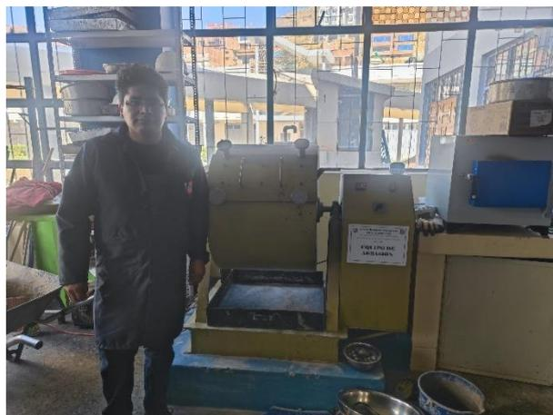
*Fotografía 3. ensayo de abrasión*
