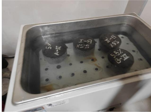
*Fotografía 10. Ensayo de flujo*
