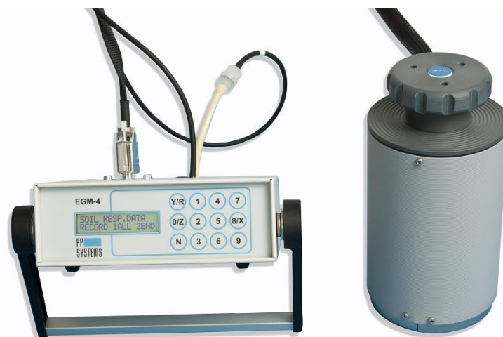
Figura 1. Analizador de gases infrarrojo (IRGA) (EGM-4, PP Systems, USA) y cámara de respiración (SRC-1, PP Systems, USA).
