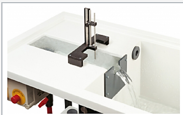
Módulo básico para ensayos sobre la mecánica de fluidos con vertedero de cresta delgada HM 150.03
