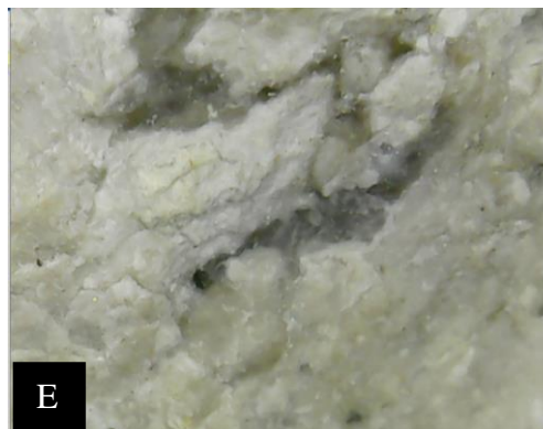
Figura 54. Muestra de caliza (A). Pirolusita como agregado dendrítico (B), microcristales de calcita (C), geodas y venillas de calcedonia (D y E).
