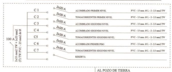
DIAGRAMA UNIFILAR TABLERO DE SERVICIOS GENERALES
