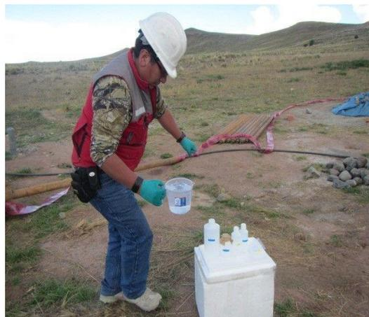
**Comentarios:** En las imágenes apreciamos los trabajos de seguimientos y control ambiental, instalación de HIVOL las 24 horas, para muestrear la calidad del aire y tomas de muestras de agua para su respectivo análisis según los protocolos establecidos.
