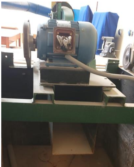
Soporte metálico de la turbina
