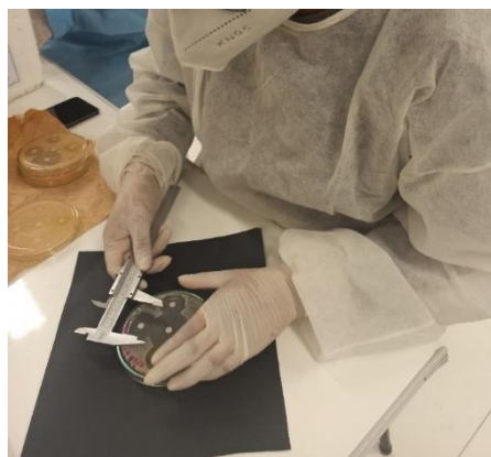
Figura 37. Medición de los halos de inhibición con un calibrador.
