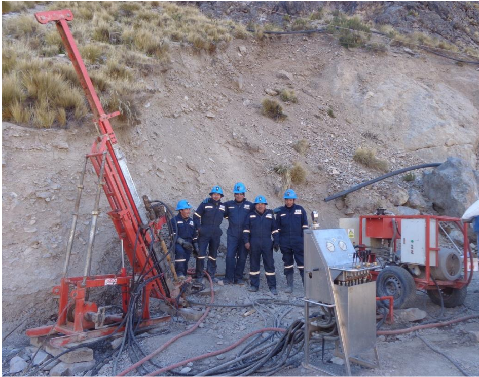
Figura 9. Maquina Explorer diamantina Junior 60E, equipo de perforación diamantina
