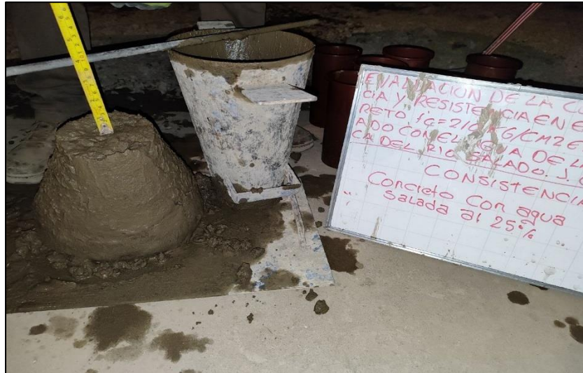
Fotografía 13. SLUMP con 25% de agua salada.
