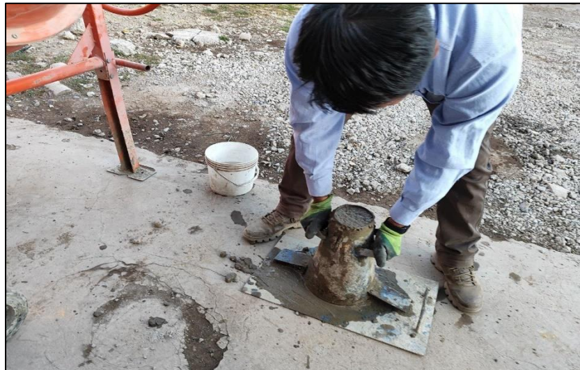
Fotografía 10. Vaciado del concreto en el molde de cono de Abrams.
