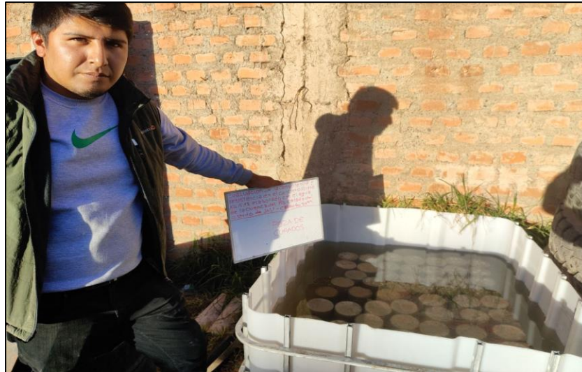
Fotografía 19. Curado de las muestras de concreto.
