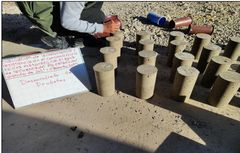
Fotografía 16. Etiquetado de las probetas de concreto.
