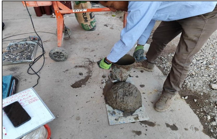
Fotografía 9. Asentamiento del concreto.
