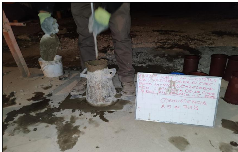
Fotografía 18. Chuseado del concreto en el molde de cono de Abrams.
