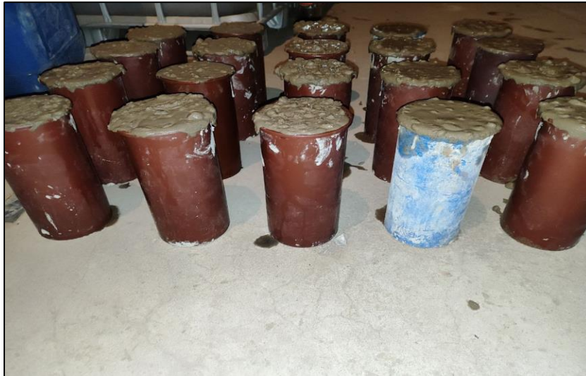
Fotografía 15. Concreto en moldes cilíndricos.
