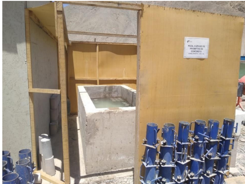
Figura 32. Curado de los testigos de concreto con distintos porcentajes de adición de plástico PET reciclado.
