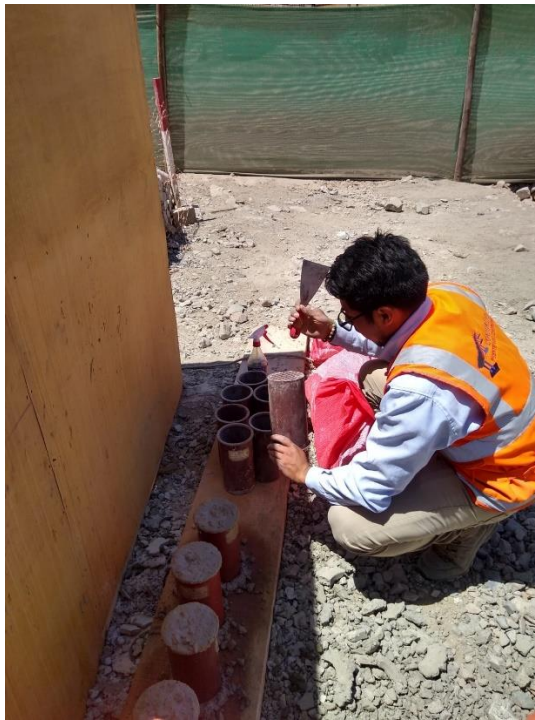
Figura 38. Especímenes de concreto con diferentes cantidades de adición de PET para realizar la prueba de resistencia.
