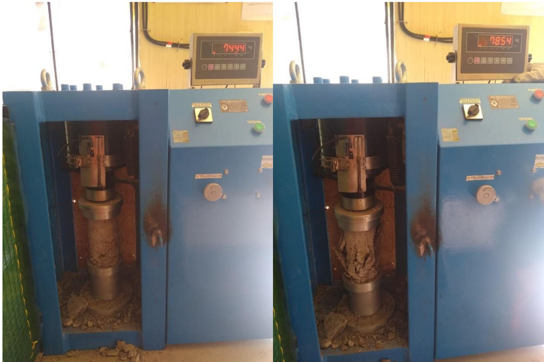
Figura 42. Restos de los especímenes de concreto después de realizar ensayos de resistencia a compresión.
