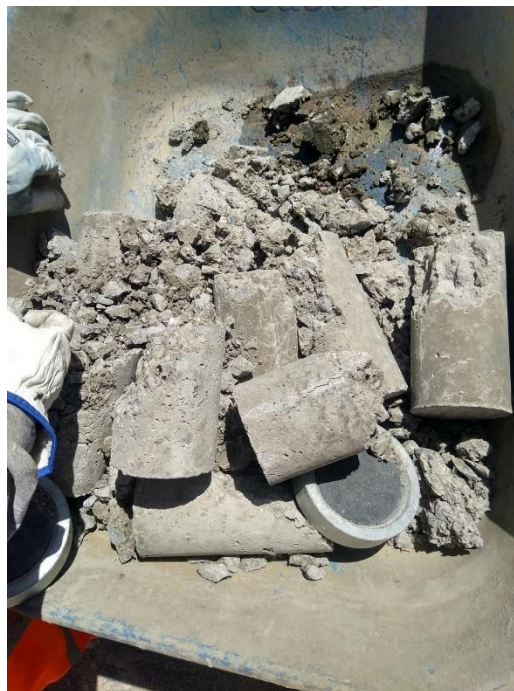
Figura 42. Restos de los especímenes de concreto después de realizar ensayos de resistencia a compresión.
