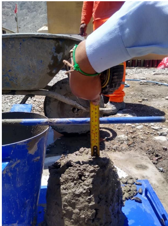
Figura 35. Realizando otro tipo de ensayo del concreto en estado fresco (Slump).
