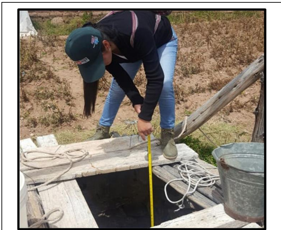
FOTOGRAFIA N° 1 COMENTARIO: Control de nivel freático de pozo, ubicado en la Zona Alta de la microcuenca EVENTO: Salida de campo LUGAR: Microcuenca Jayllihaya-pozo N°07
