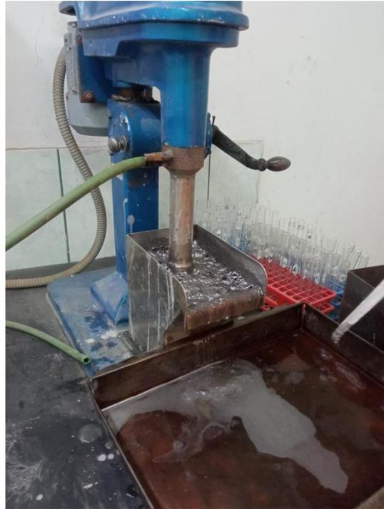
**Anexo 5.** Prueba de flotación en el laboratorio
