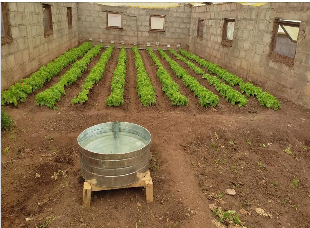
*Fotografía 06.* Tanque de evaporímetro tipo A
