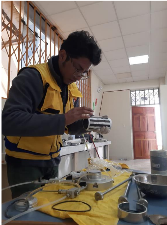
PREPARACIÓN DE MUESTRA PARA ENSAYO TRIAXIAL EN MUESTRA MH
