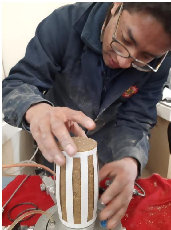
PREPARACIÓN DE MUESTRA PARA ENSAYO TRIAXIAL EN MUESTRA GC
