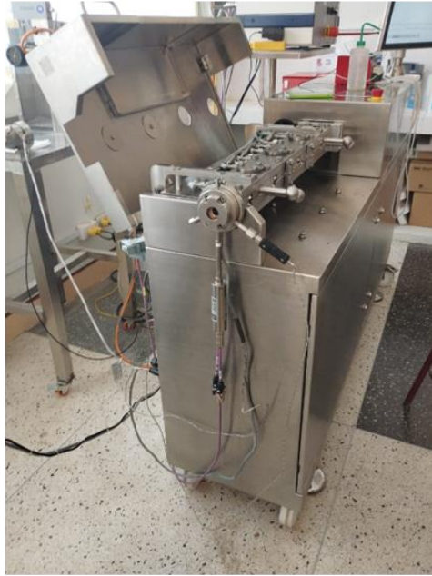
Extrusora de doble husillo (Brabender TwinLab-F 20/40, Alemania) acondicionada para su posterior utilización
