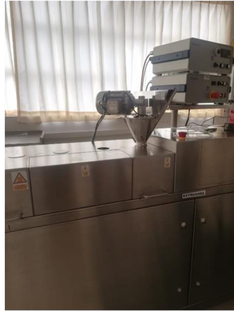
Extrusora de doble husillo (Brabender TwinLab-F 20/40, Alemania) acondicionada para su posterior utilización
