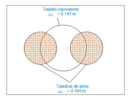
1.2 Diagrama geométrico general de un arrancador de orificios paralelos de cuatro secciones.
