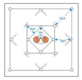
Nota: Esquema geométrico general de un arranque de cuatro secciones con barrenos paralelos.
