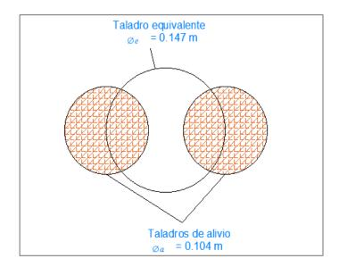
Nota: Diseño de taladro equivalente vacío.
