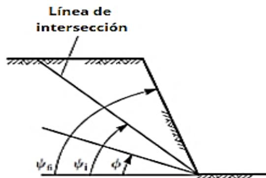
Nota: En la vista isométrica se visualiza la cuña. El análisis estereográfico destaca la orientación de la línea de confluencia de planos y el rango de inmersión de la misma, indicando las condiciones en las cuales la rotura es posible. La vista del talud perpendicular a la línea de intersección se muestra en, mientras que el estereograma ilustra el rango de ocurrencia de la línea de intersección  $\alpha i$  donde la falla por cuña.
