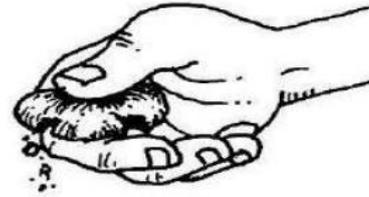
Si la bolita se rompe, la tierra **NO** sirve ya que no tiene suficiente arcilla y los adobes no serán resistentes.
