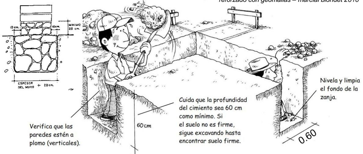
**IMAGEN N° 219.** Excavación de cimientos.
