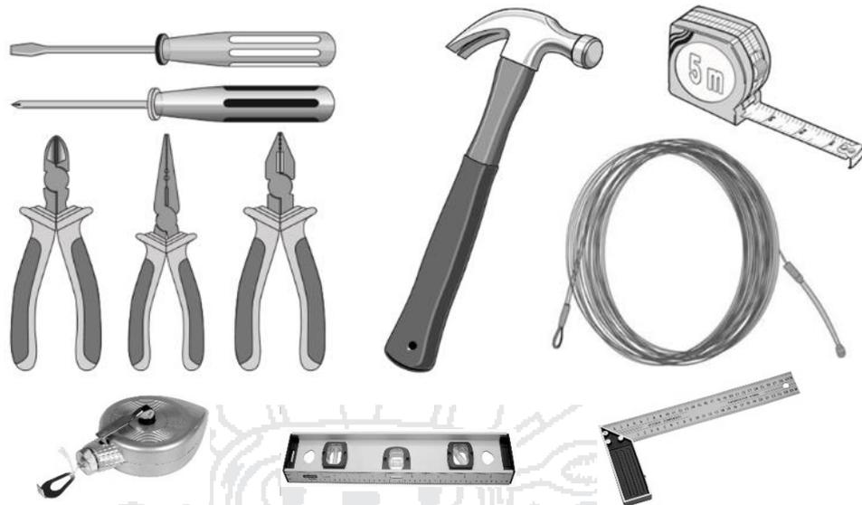
**IMAGEN N° 255.** Herramientas básicas para una instalación eléctrica.
