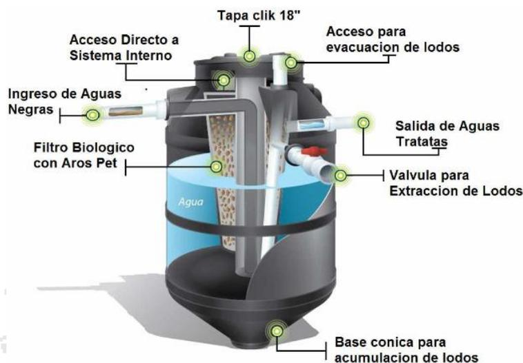
**IMAGEN N° 135.** Diseño y funcionamiento del BIO-DIGESTOR.
