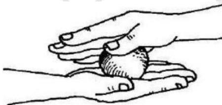
**IMAGEN N° 198.** Prueba de resistencia – prueba de bolita.
