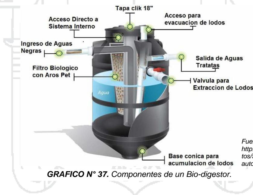
**GRAFICO N° 37.** Componentes de un Bio-digestor.
