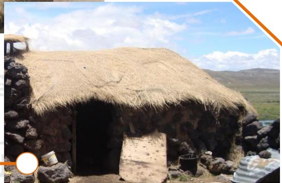
La otra técnica es la del **CHOLQO**, consiste en mezclar o entreverar la paja SHIJNIW de modo que la paja quede tendida sobre la estructura para formar el techo, diseminándola de forma uniforme y que el abultamiento y/o el espesor tenga una sola altura, y cubrir el techo por completo.
