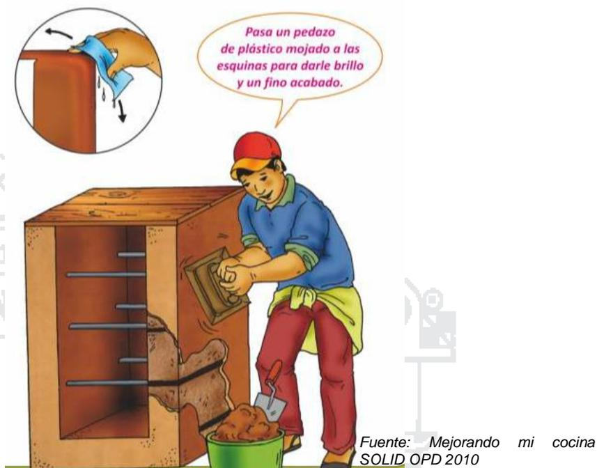
**IMAGEN N° 172.** Acabado interior y exterior de refrigerador ecologico.
