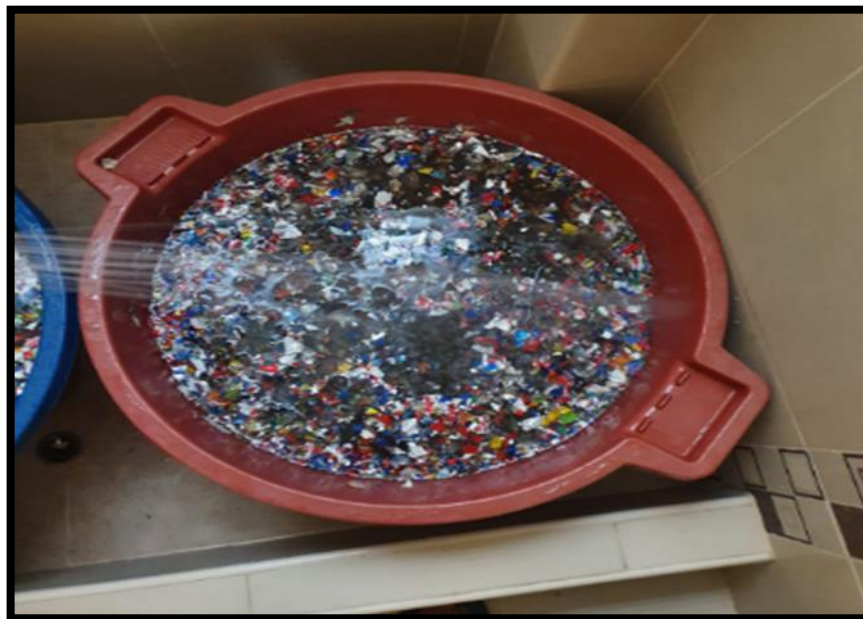
Figura 10. Lavado de hojuelas de Tereftalato de Polietileno
