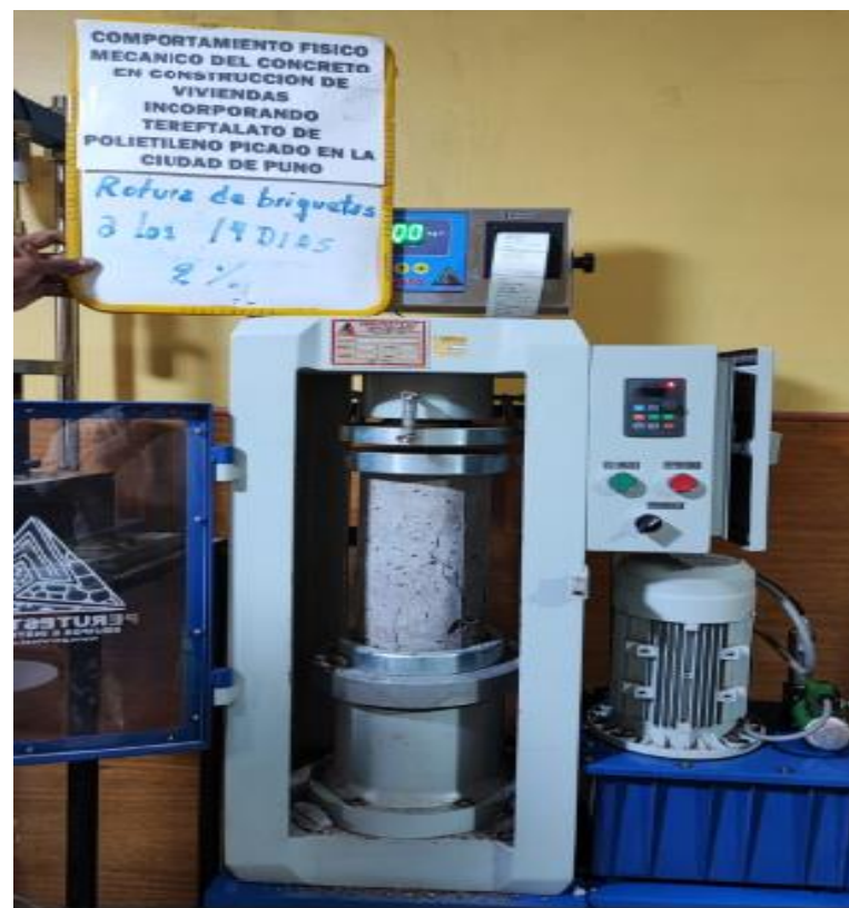
Figura 16. Rotura de briquetas a los 14 días, 2% falla por fisura tipo falla 3
