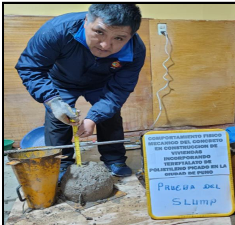
Figura 9. Medición de Slump
