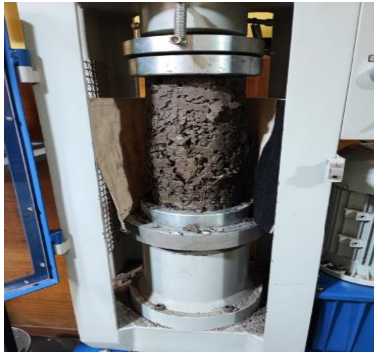
Imagen 11. Rompimientos De Briqueta A Fuerza Uniaxial Alos 14 Dias Al 4%
