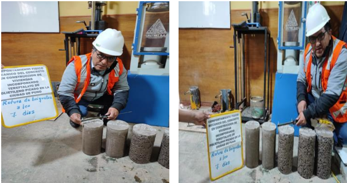
Imágen 9. Preparación Y Medición Para Roturas De Briquetas A Los 7 Días
