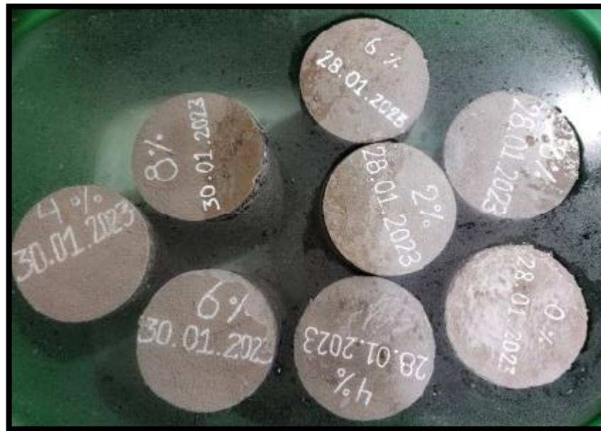
Figura 13. Curado por inmersión de briquetas por 7 días, 14 días y 28 días en poza de curado
