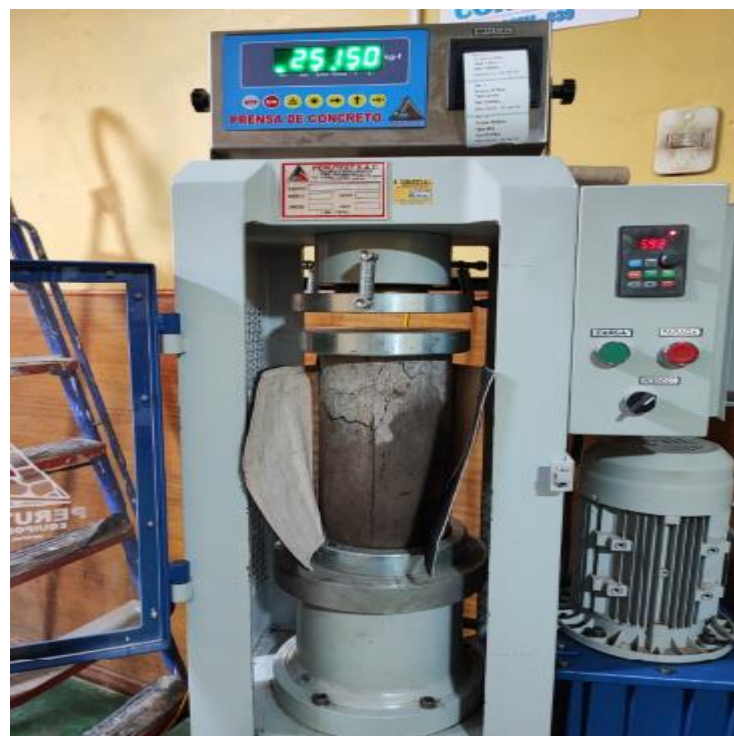
Imagen 12. Rompimientos De Briqueta - Fuerza Uniaxial Alos 28 Dias Al 2%
