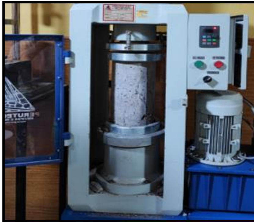
Figura 17. Rotura de briquetas a los 14 días, 2% falla por fisura tipo 3
