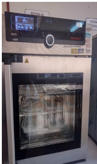
Secado de quinua por estufa de convección
