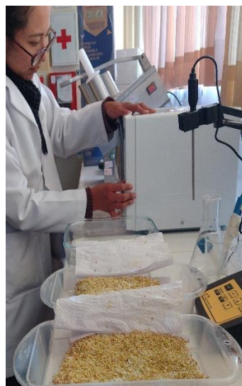
Secado de quinua por microondas
