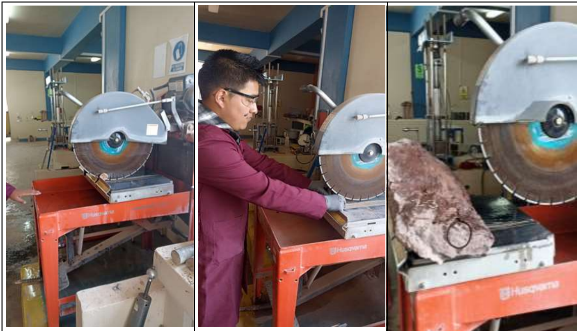
Fotografía N°10. Cortado para los testigos para la parte superior e inferior, como también para las pequeñas muestras que son usadas para determinar las propiedades físicas.
