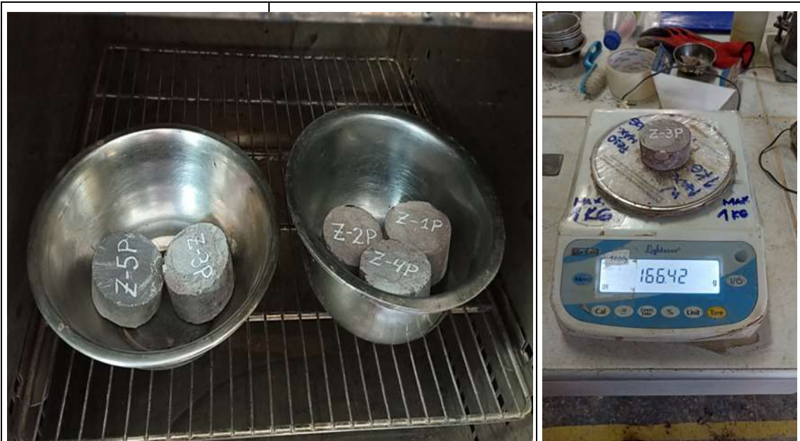
Fotografía N°13. Las muestras en el horno, luego pesadas para determinar su peso seco.
