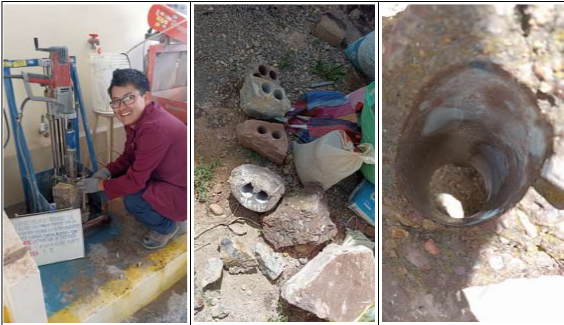
Fotografía N°9. Perforación de las muestras, en la elaboración de 03 testigos por cada zona determinada.
