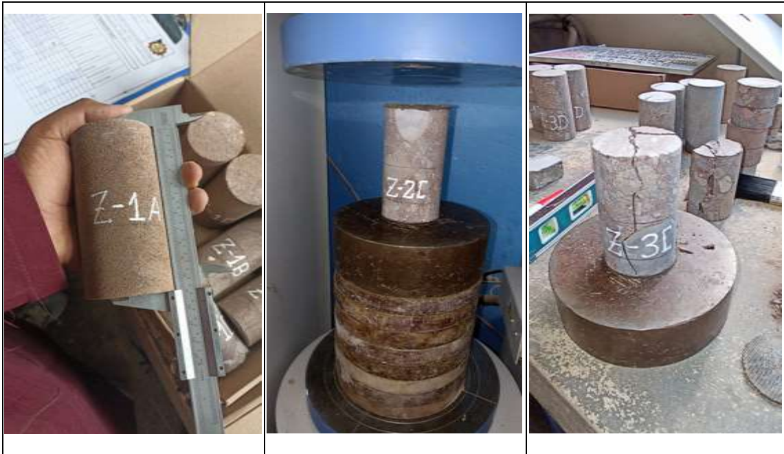
Fotografía N°19. Medición de todos los testigos, luego son sometidos en la prensa ADR1500 para el ensayo de compresión simple.
