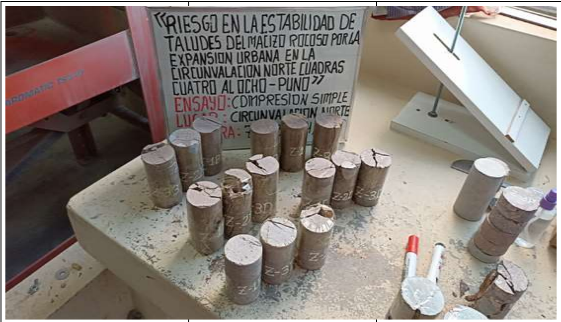
Fotografía N°21. Se visualiza los 15 testigos sometidos a compresión simple, donde se envolvió con una cinta de embalaje para visualizar con más detalle las roturas presentadas.
