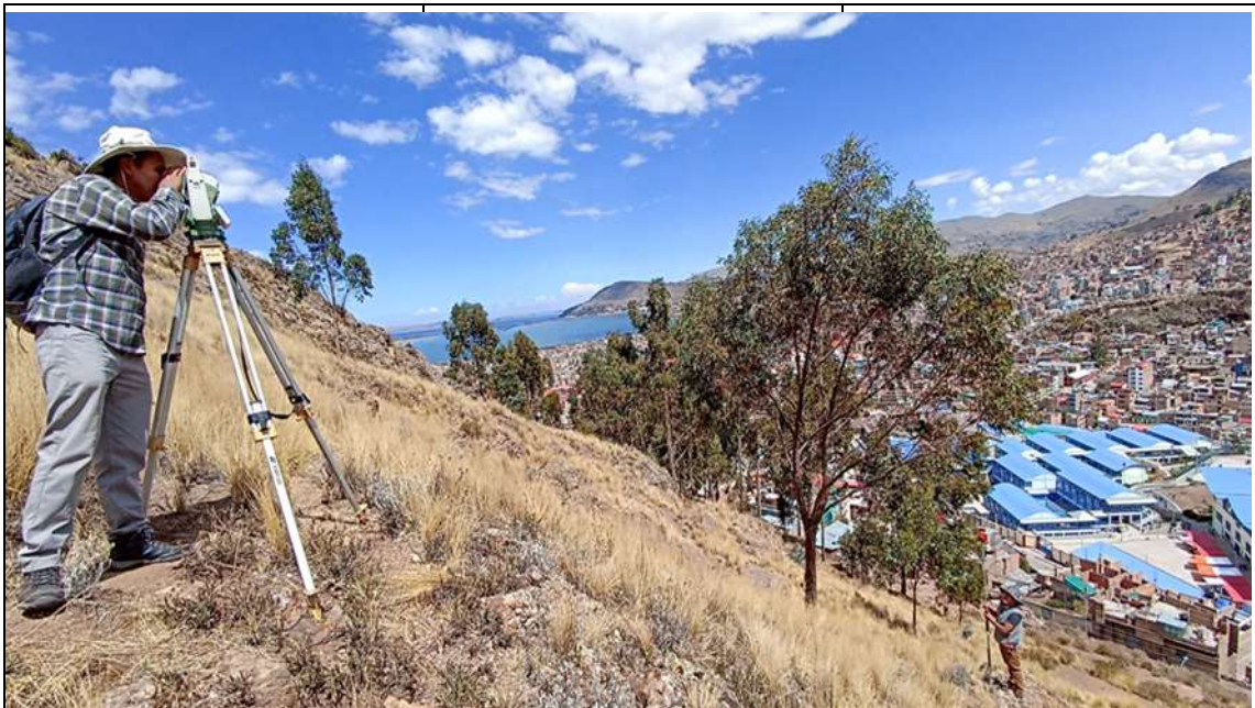
Fotografía N°4. Levantamiento topográfico con estación total en la zona 01.
