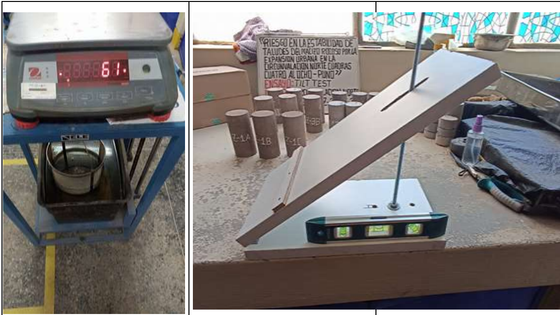
Fotografía N°15. Las muestras saturadas se vuelven a pesar para para determinar su volumen. Se muestra el equipo para realizar el ensayo de Tilt test que este nivelado y adecuado para su uso.
