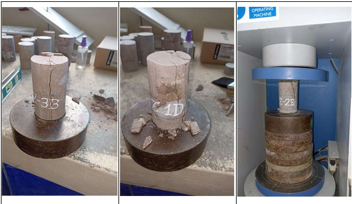
Fotografía N°20. Se muestra los diferentes testigos en rotura.
