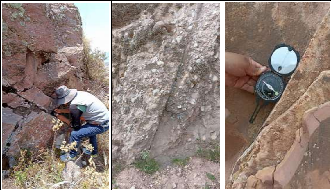
Fotografía N°6. Lecturando con la brújula el buzamiento y la dirección de buzamiento de las discontinuidades presentes en la zona de estudio.
