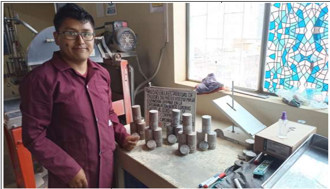
Fotografía N°18. Se muestra los testigos realizados 03 por zona y 01 muestra de las propiedades físicas. Para luego ser sometidas a ensayo de compresión simple.
