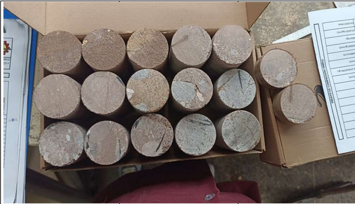
Fotografía N°11. Terminados los 15 testigos y 05 muestras para propiedades físicas, son almacenadas en una caja para su cuidado y no haya otras intervenciones.
