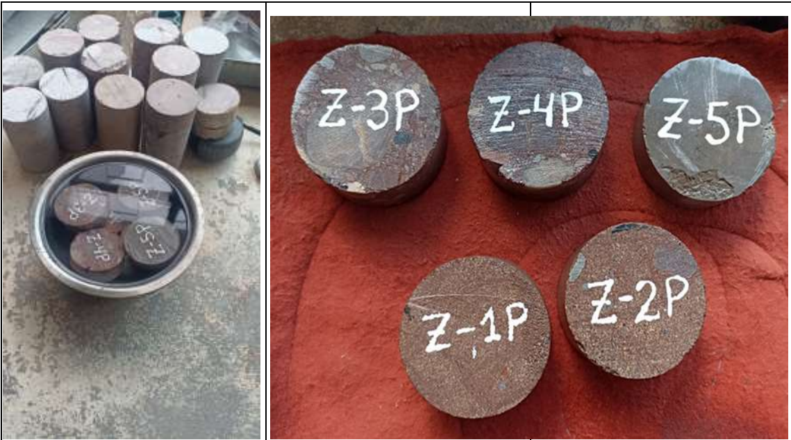
Fotografía N°14. Se saturan las muestras por un lapso de dos días para su determinación del peso saturado.
