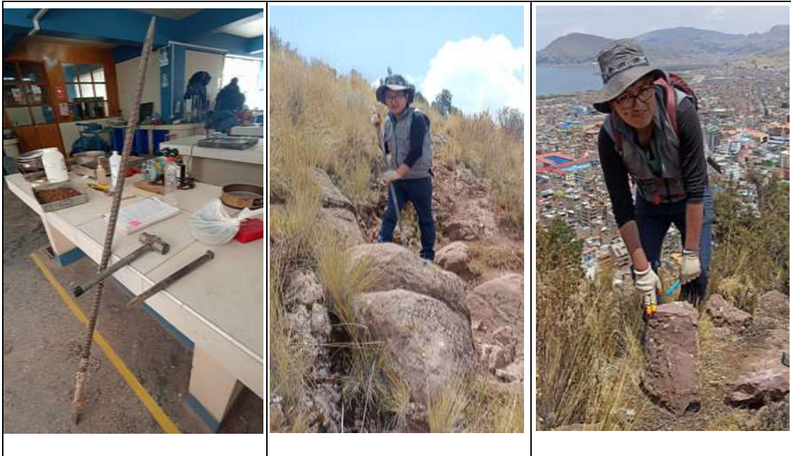
Fotografía N°8. Se visualiza barreta, martillo y cincel. Utilizado para la extracción de muestras para laboratorio.
