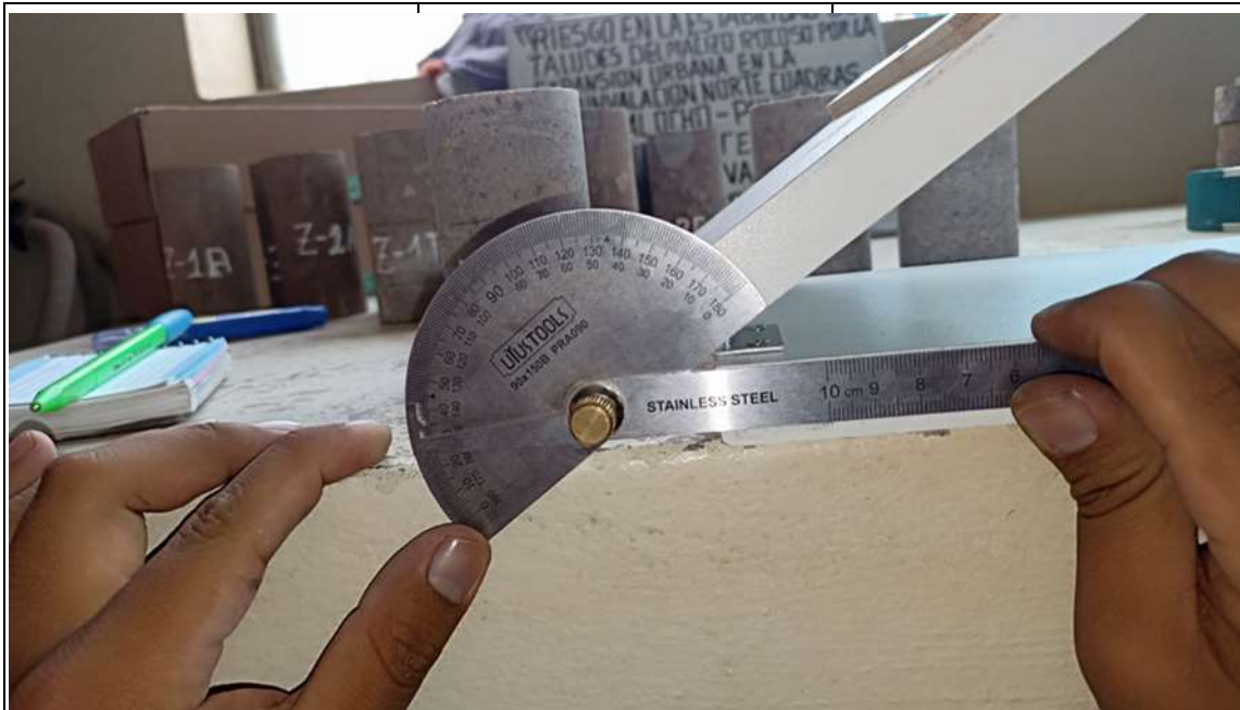
Fotografía N°17. Se usa el transportador metálico para medir el ángulo de inclinación donde se deslizo el testigo analizado.
