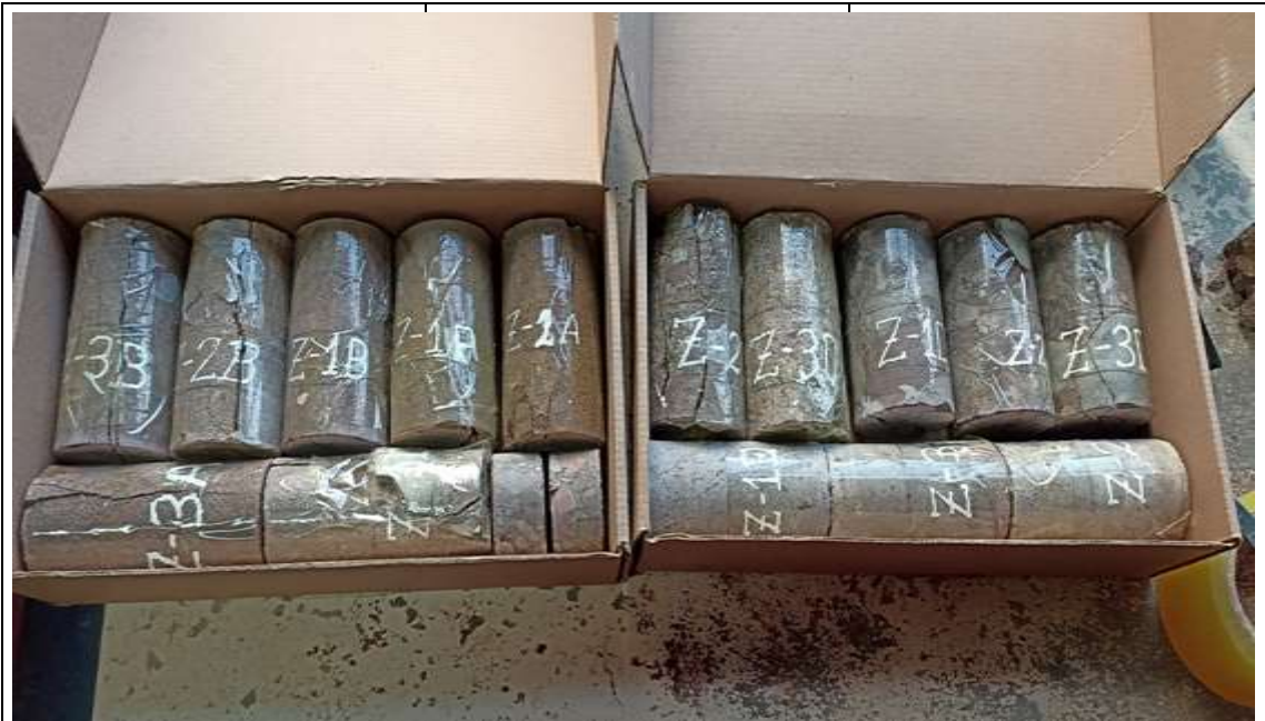
Fotografía N°22. Se visualiza a los 15 testigos sometidos a la fuerza de compresión y a las 05 muestras de las propiedades físicas, finalmente almacenadas en dos cajas.
