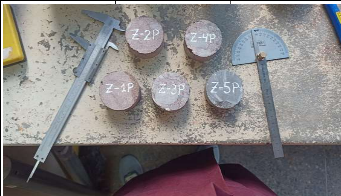
Fotografía N°12. Las 05 muestras medidas y pesadas para ser luego colocadas al horno, y tener su peso seco.
