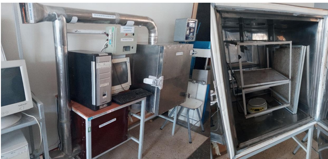
Figura 4.F: Equipo secador de lecho fijo
