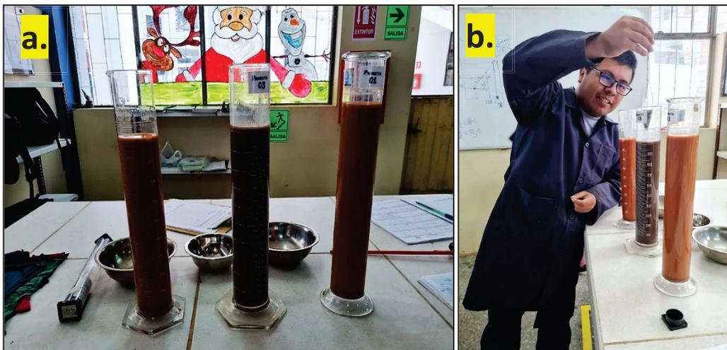
*Nota:* a) muestras. b) prueba de granulométrica con el hidrómetro.
