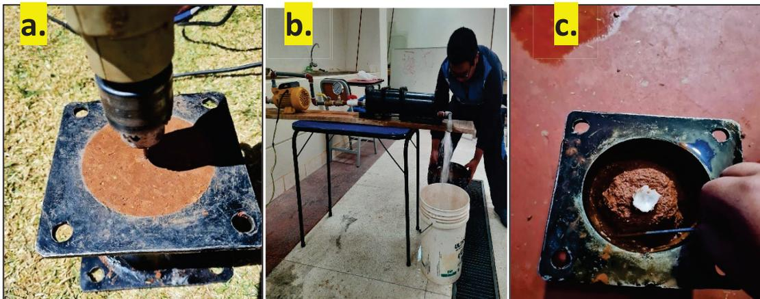
*Nota:* a) preparación de la muestra. b) equipo de la tubificación. c) muestra con la parafina.
