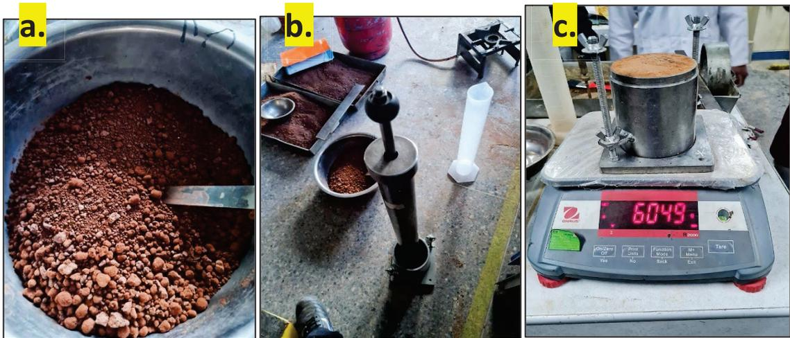
*Nota:* a) muestra natural. b) instrumento de Proctor modificado. c) Proctor modificado.
