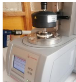
Análisis reológico de los tratamientos en el Reómetro Modular Compacto Anton Paar.
