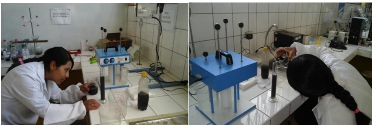
Figura 29. Preparando concentración de LX para procedimiento coagulación
