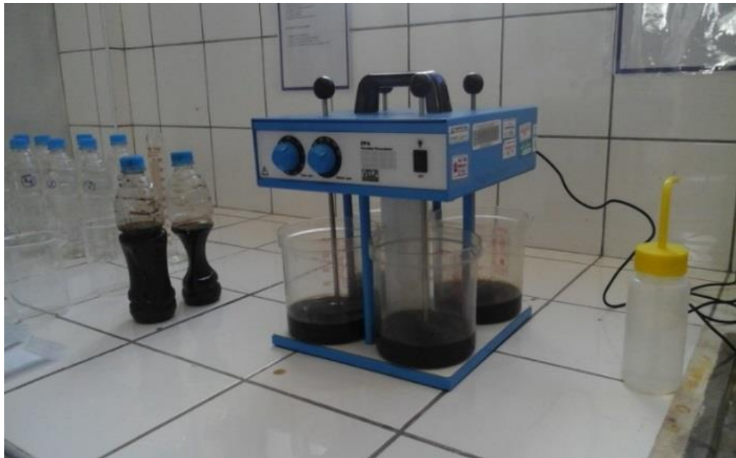
Figura 11. Instalación experimental para experimentos coagulación-floculación
