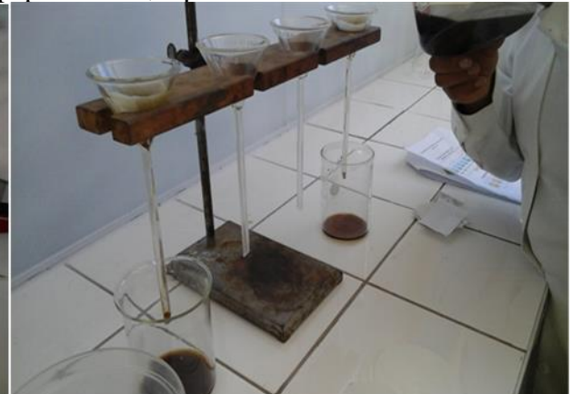
Figura 34. Filtración ejemplar tratado con papel filtro 0,45 \mu .
