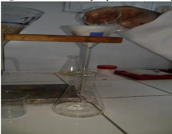
Figura 34. Filtración ejemplar tratado con papel filtro 0,45 \mu .
