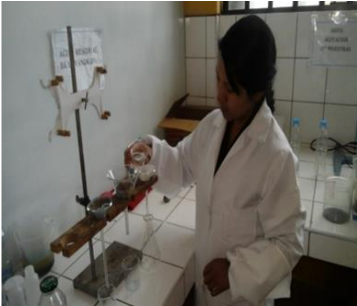
Figura 33. Filtración ejemplar tratado con papel filtro 0,45 \mu
