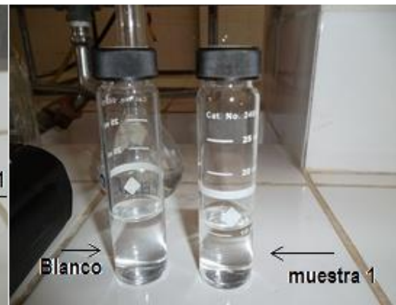
Figura 34. Filtración ejemplar tratado con papel filtro 0,45 \mu .
