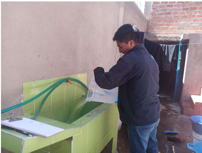
Fotografía 09. Medición de recipientes utilizados por el usuario con el balde de 10 litros.
