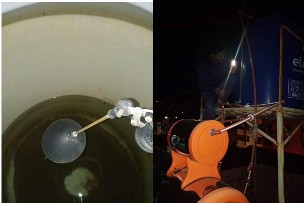
Fotografía 08. Medición nocturna del nivel de agua del tanque elevado
