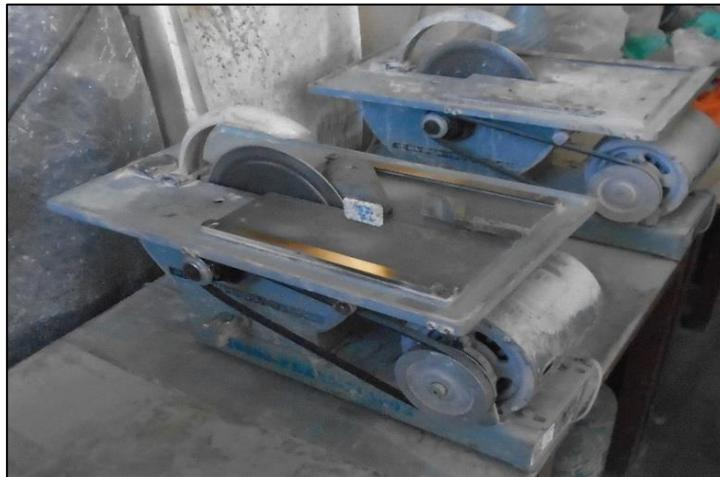
Para la preparación de secciones pulidas se realizó el corte de la roca en forma de cilíndrica con una sierra diamantada. Luego se realiza un nuevo corte para reducir el espesor de la muestra con una sierra más fina. Posteriormente se procede a pulir la muestra con abrasivos (Carburo de silicio) de diferentes diámetros (No. 170, 400, 800, 1500 y 3000)., Finalmente, se coloca la muestra en un pulidor automático durante una hora.
