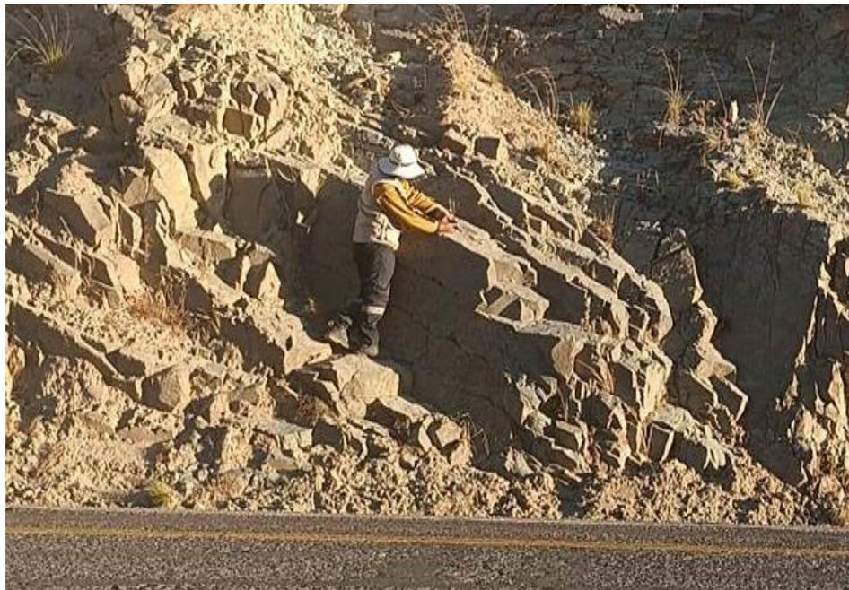
**Fotografía 04.** Toma de datos de buzamiento y dirección de buzamiento, en la progresiva Km. 233+540.
