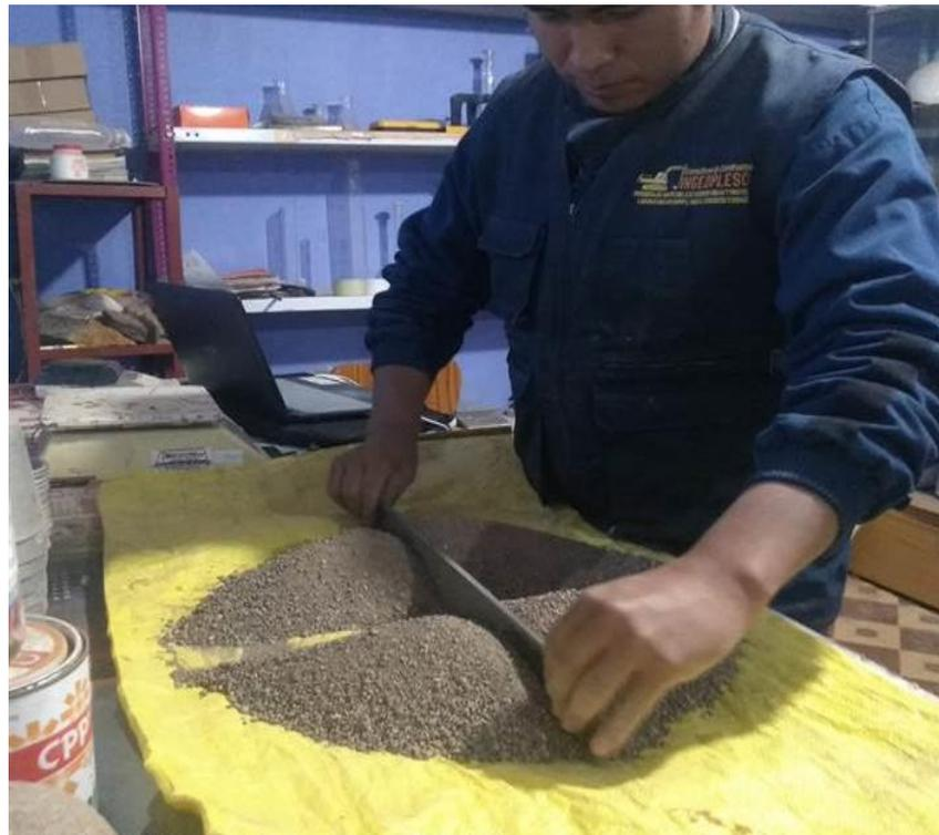
**Fotografía 06.** Realización del cuarteo de la muestra en el laboratorio.
