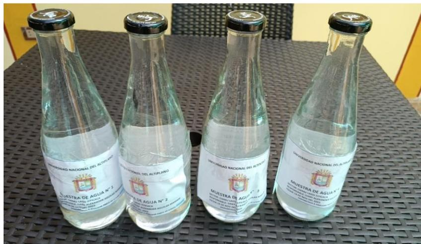
Filtrado de agua (0.5 L) con carbón activado en polvo tiempo de filtrado 12.8 minutos promedio el agua turbia obtenido del sector chimú se convierte claramente en un agua cristalina se realizaron 12 repeticiones con diferentes cantidades de carbón activado en polvo y granulado el proceso están en la Figura 11.
