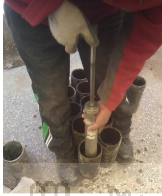
Figura 4. 18 Muestra el compactado del concreto permeable
