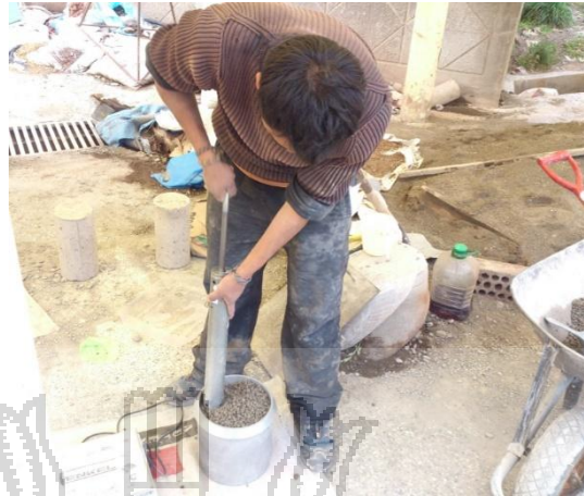
Figura 4. 12 Compactación del agregado permeable
