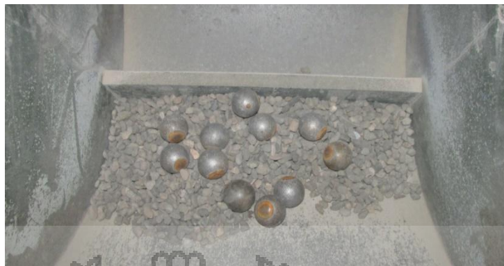
Figura 3. 15 Árido reciclado siendo introducido en la máquina de Los Ángeles
