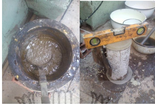
Figura 4. 20 Muestra poniendo ácido sulfúrico (capping)
