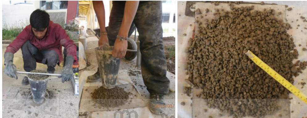
Figura 4. 16 Ensayo del cono invertido en el concreto poroso
