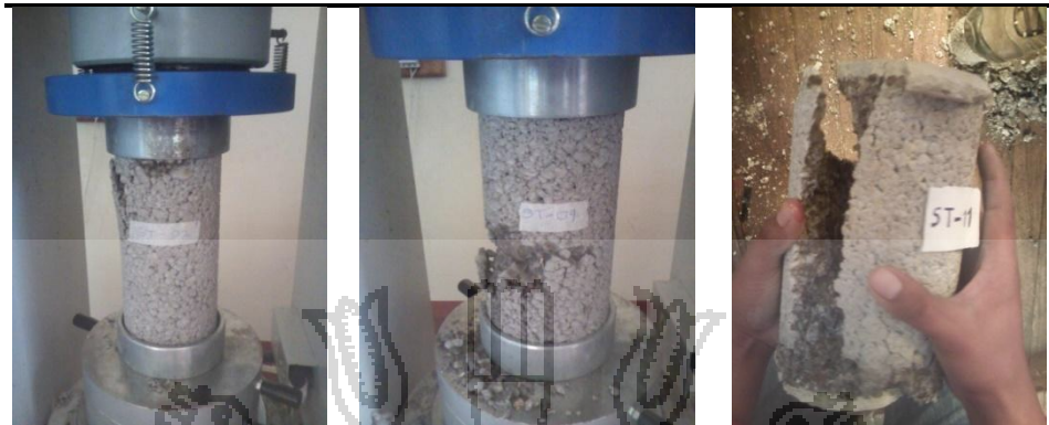
Muestra la Probeta con falla de corte y fisuras en el extremo de la briqueta, a los 7 días. (2do Diseño – Huso 8) Muestra la Probeta con falla de corte, a los 14 días. (2do Diseño – Huso 8) – Sin tiras Muestra la Probeta falla por corte, a los 28 días. (2do Diseño – Huso 8) – Sin tiras
