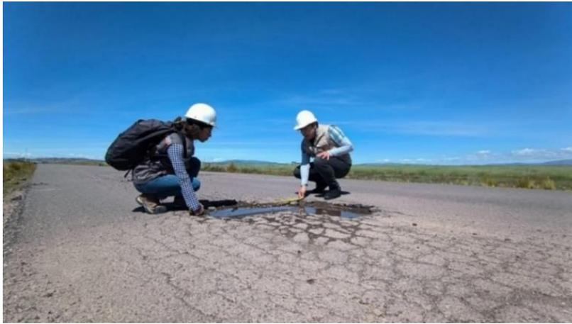
Nota: La imagen muestra la medición de fallas (hueco), en la vía. Elaboración propia.
