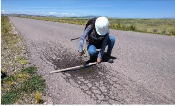
Medición de fallas en el eje z
