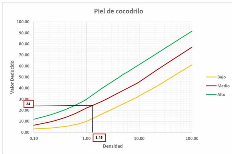
Nota: La figura muestra la densidad hallada en el eje de las abscisas para severidad media obteniendo un valor deducido de 24 en el eje de las ordenadas. Adaptado de: *Procedimiento estándar para la Inspección de Índice de Condición de Pavimento de Caminos y la Inspección de Índice de Condición de Pavimento de Caminos y Estacionamientos*, (p. 68), por ASTM D6433, 2018, Manual del PCI.
