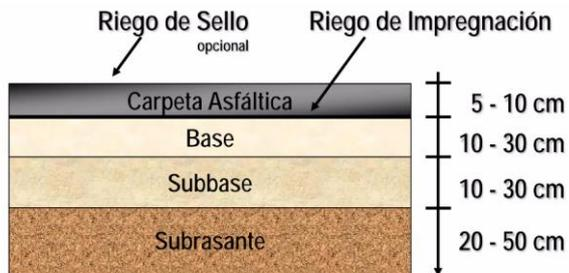
Nota: El gráfico muestra el corte transversal de capas de pavimento flexible. Tomado de: Pavimentos (p.03), por C. Giordani, D. Leone, 2020, Catedra: Ingeniería civil I.
